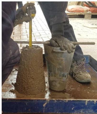
Ilustración 14 Ensayo de revenimiento realizado a mezcla de hormigón
