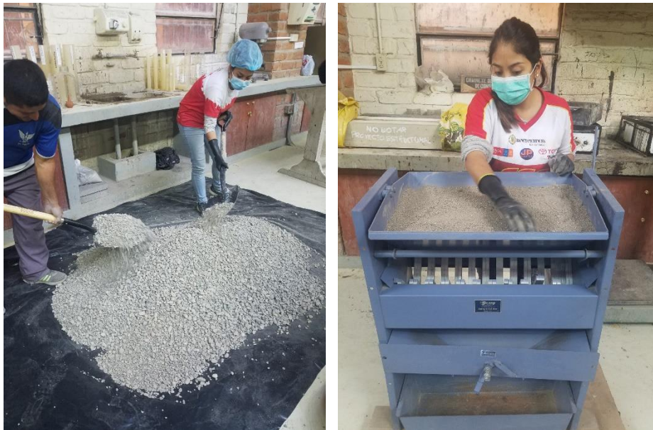
Ilustración 7 Homogenización del material – Reducción de muestra por cuarteo mecánico
