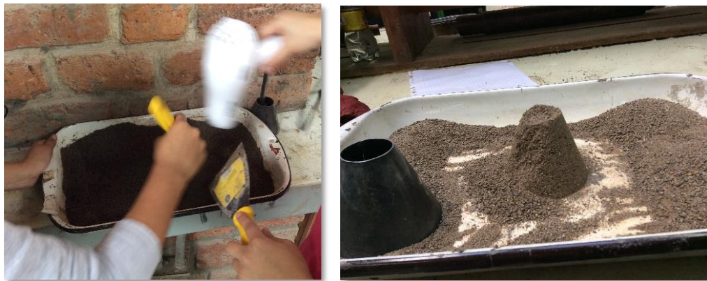
Ilustración 10 Ensayo de gravedad específica a agregado fino.
