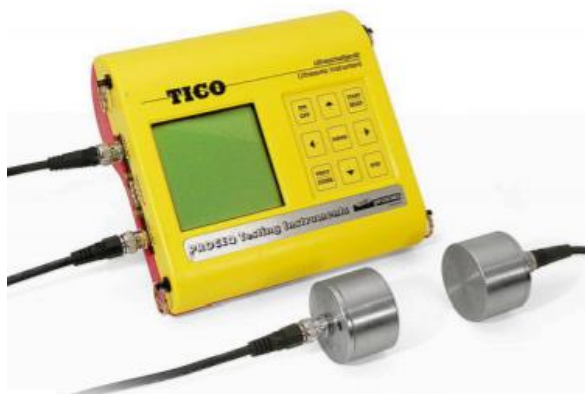
Ilustración 18 Equipo PROCEQ TICO utilizado en la determinación de la velocidad ultrasónica en probetas de hormigón
