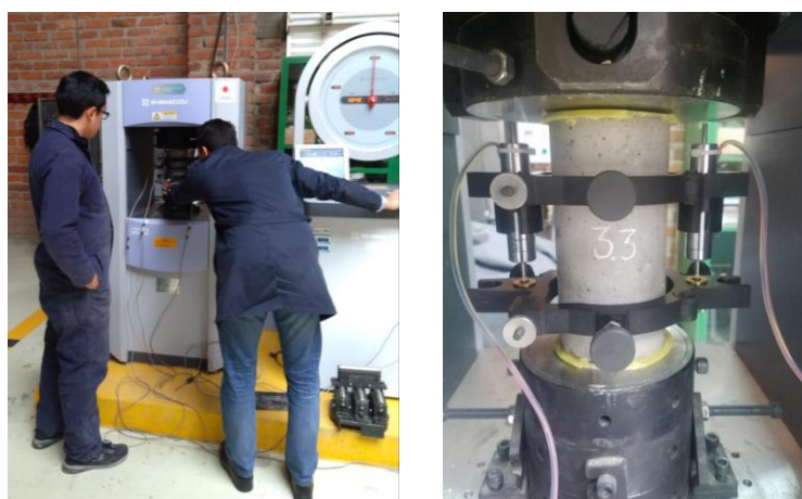
Ilustración 17 Colocación de espécimen para ensayo de módulo de elasticidad – sensores longitudinales
