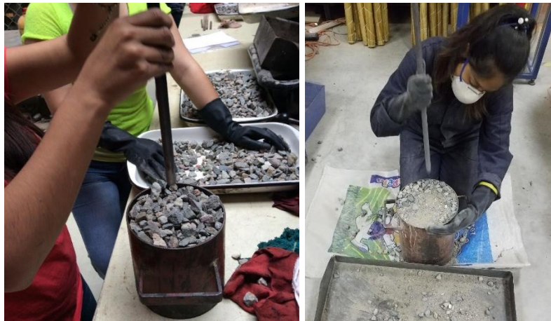
Ilustración 11 Ensayo de peso unitario compactado a agregado grueso y agregado combinado.
