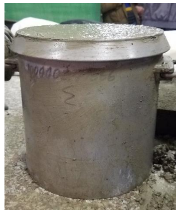
Ilustración 15 Realización del ensayo de peso unitario a una de las mezclas de hormigón
