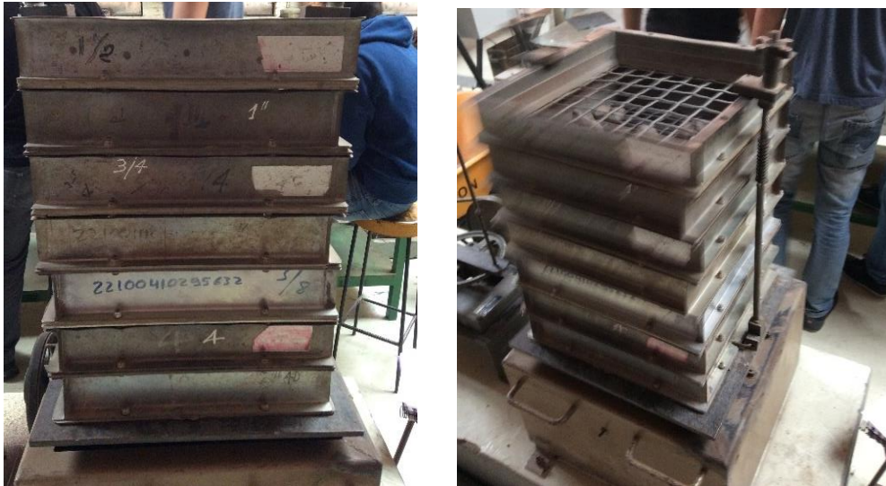
Ilustración 8 Serie de tamices para agregado grueso – Ensayo de granulometría
