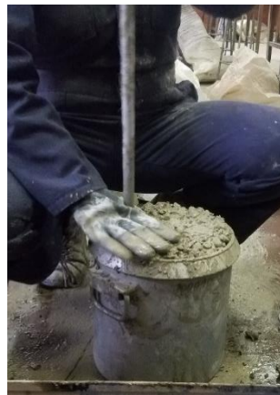
Ilustración 15 Realización del ensayo de peso unitario a una de las mezclas de hormigón
