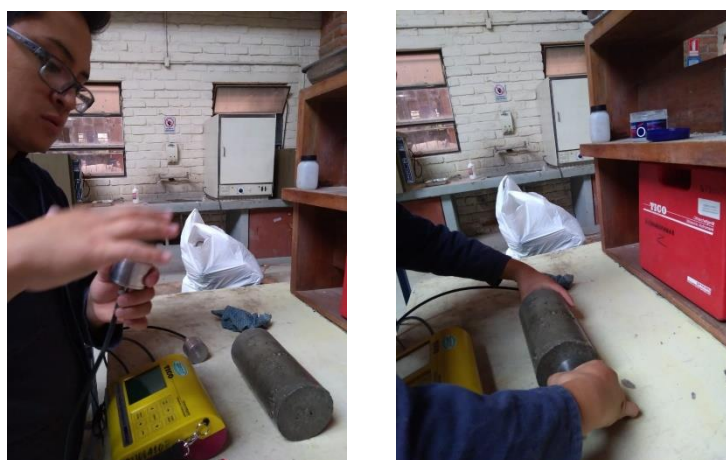
Ilustración 19 Ensayo de ultrasonido realizado a uno de los especímenes
