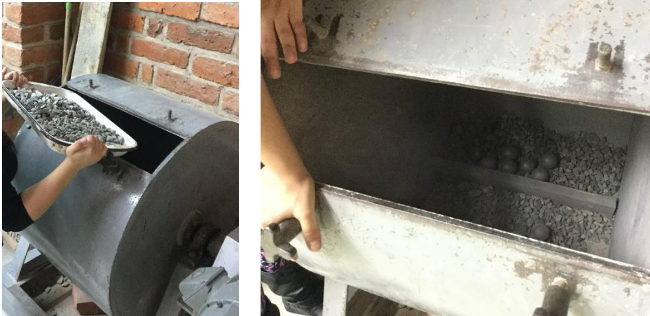
Ilustración 9 Ensayo de abrasión realizado a agregado grueso combinado
