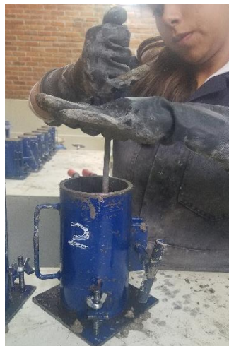
Ilustración 13 Moldeo de probetas de hormigón
