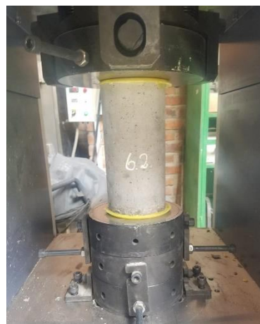
Ilustración 16 Espécimen en un ensayo a compresión
