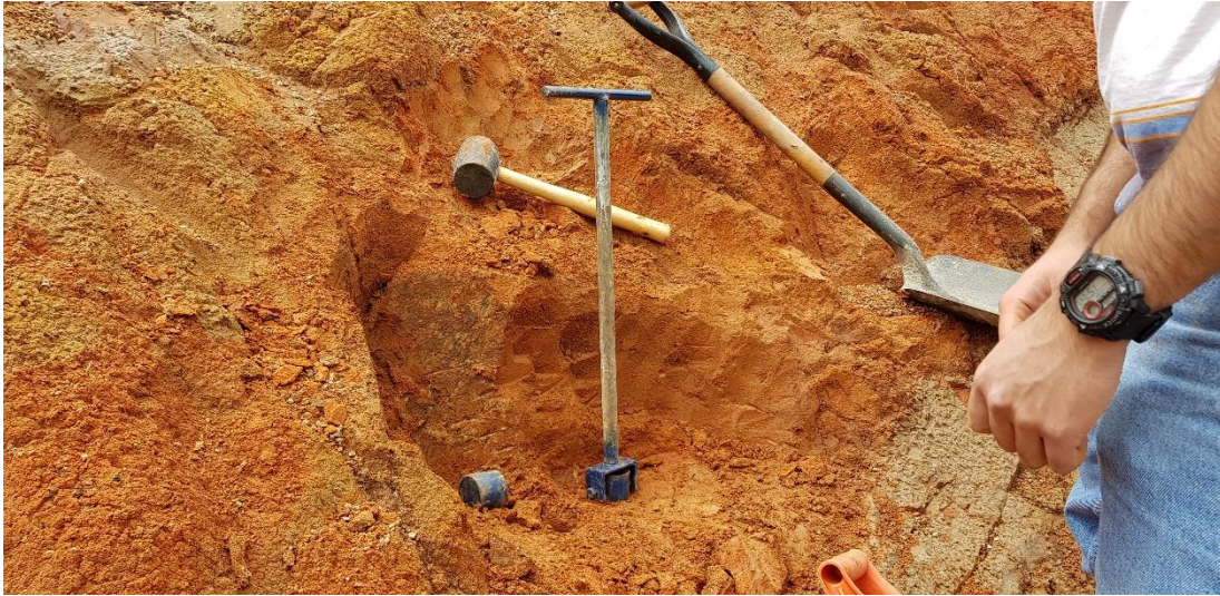
Anexo 20: Extracción de muestras suelo base – 3.
