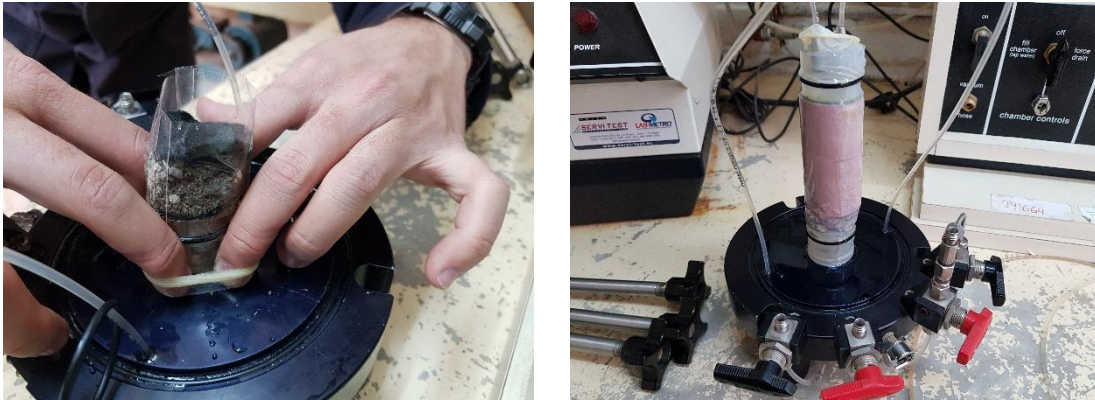
Anexo 26: Muestra con filtro geotextil.
