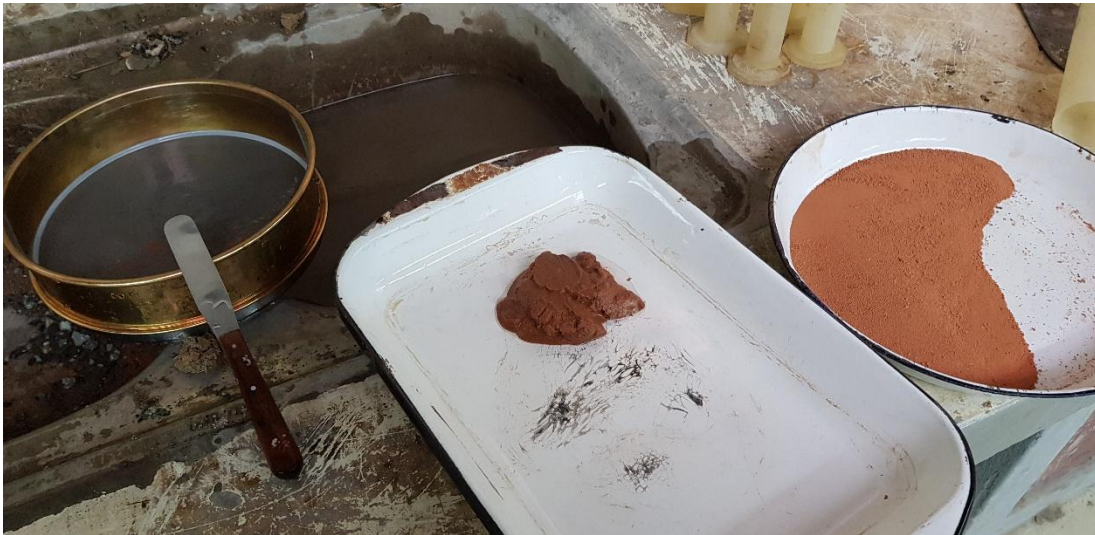
Anexo 33: Ensayo de gravedad específica.
