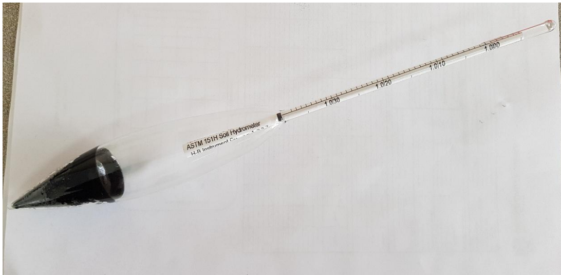
Anexo 31: Hidrómetro ASTM 151H.
