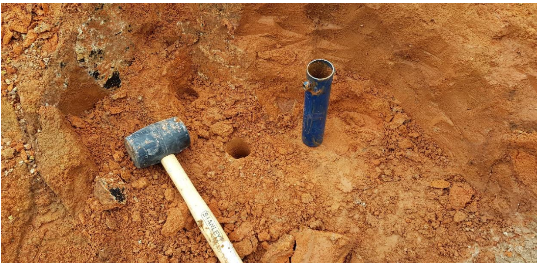
Anexo 18: Extracción de muestras de suelo base – 1.
