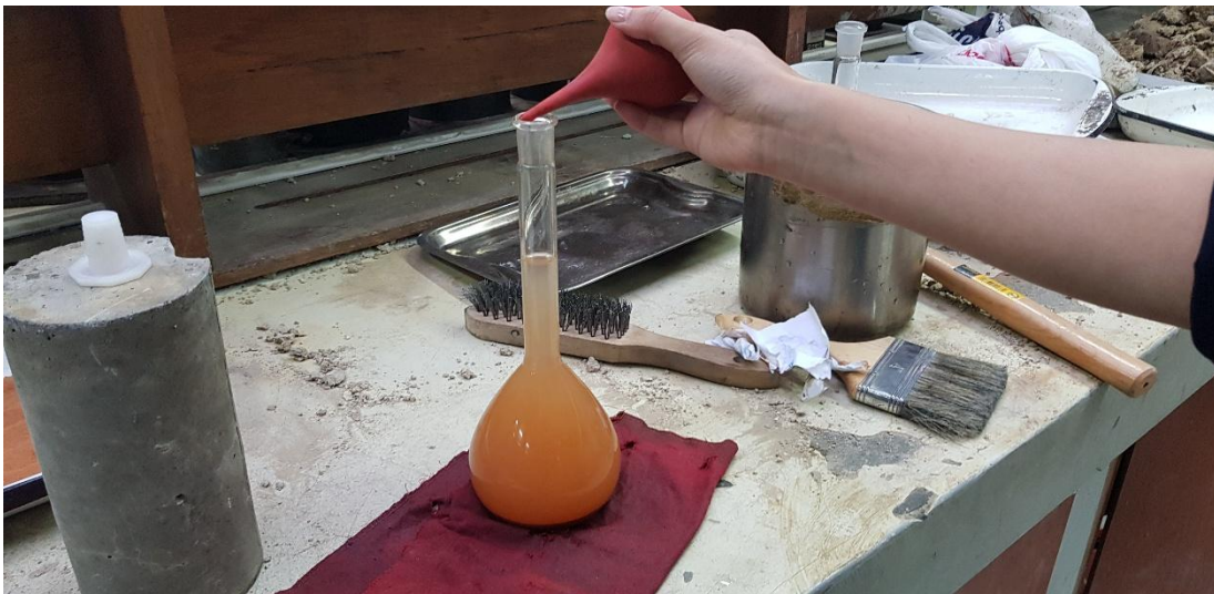
Anexo 33: Ensayo de gravedad específica.
