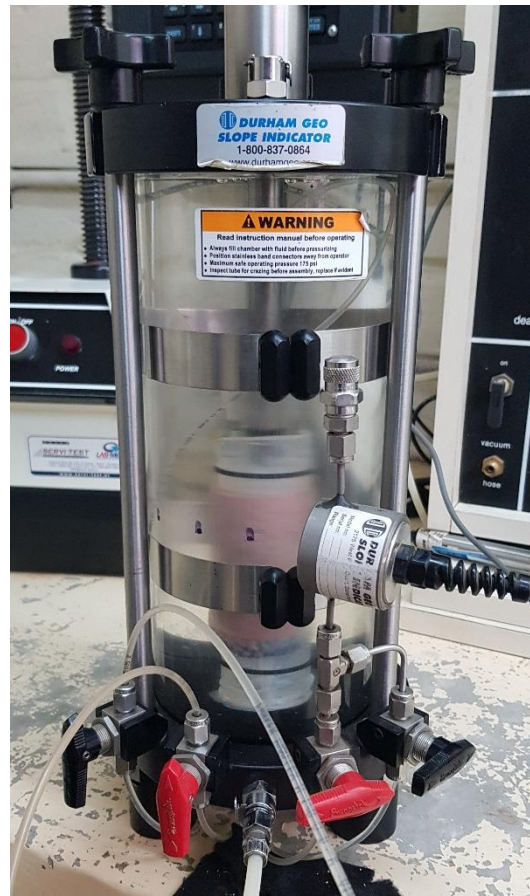
Anexo 22: Armado de muestra sin filtro.
