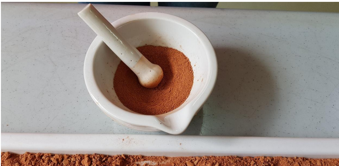
Anexo 29: Muestras de suelo para hidrómetro.
