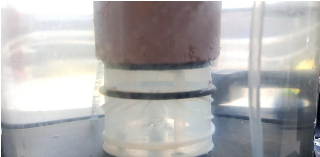
Anexo 26: Muestra con filtro geotextil.
