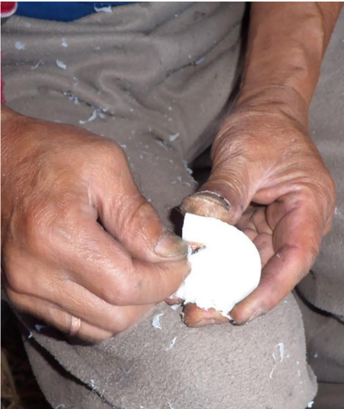
Proceso de preparación del taco para adaptarlo al calzado.
