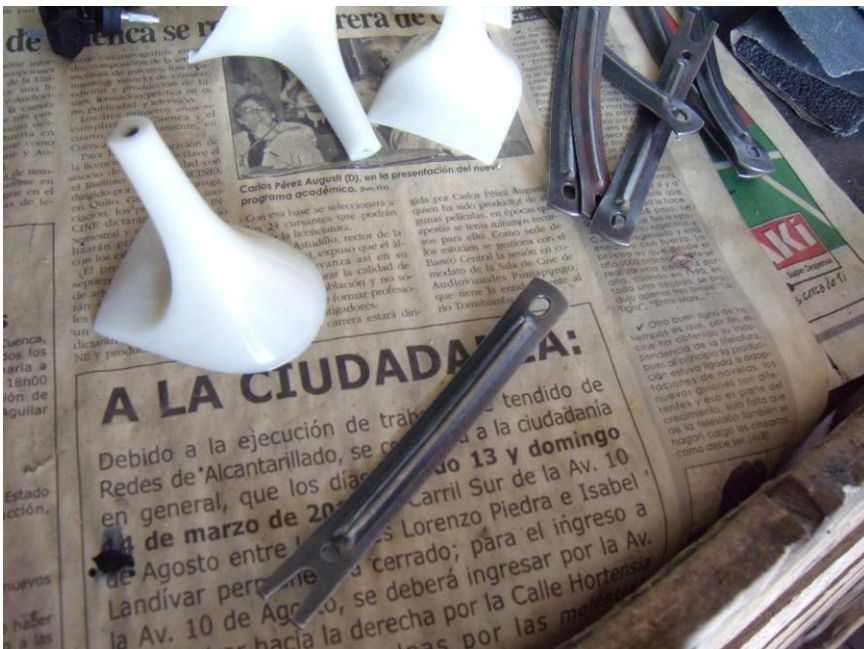
Tacos y varillas. Estos dan más altura, y rigidez al calzado.
