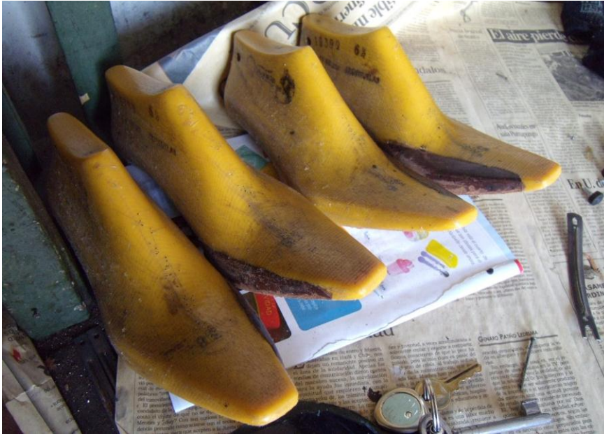
Hormas del calzado. Sirven para dar forma e ir moldeando el zapato durante su elaboración.
