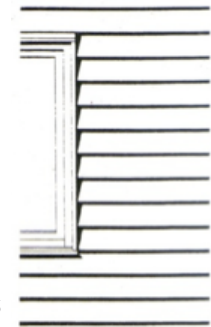
F26: Tablas solapadas
