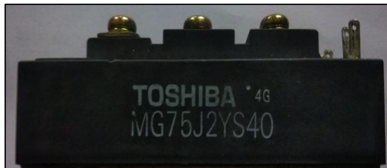
Figura 4.10. Módulo IGBT MG75J2YS40
