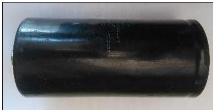
Figura 4.7. Capacitor de 6800u.
