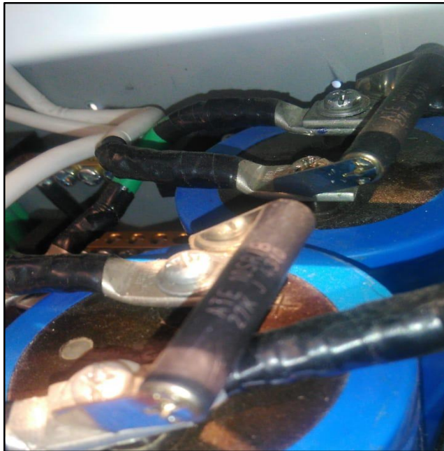
Figura 4.8. Resistencias de ecualización
