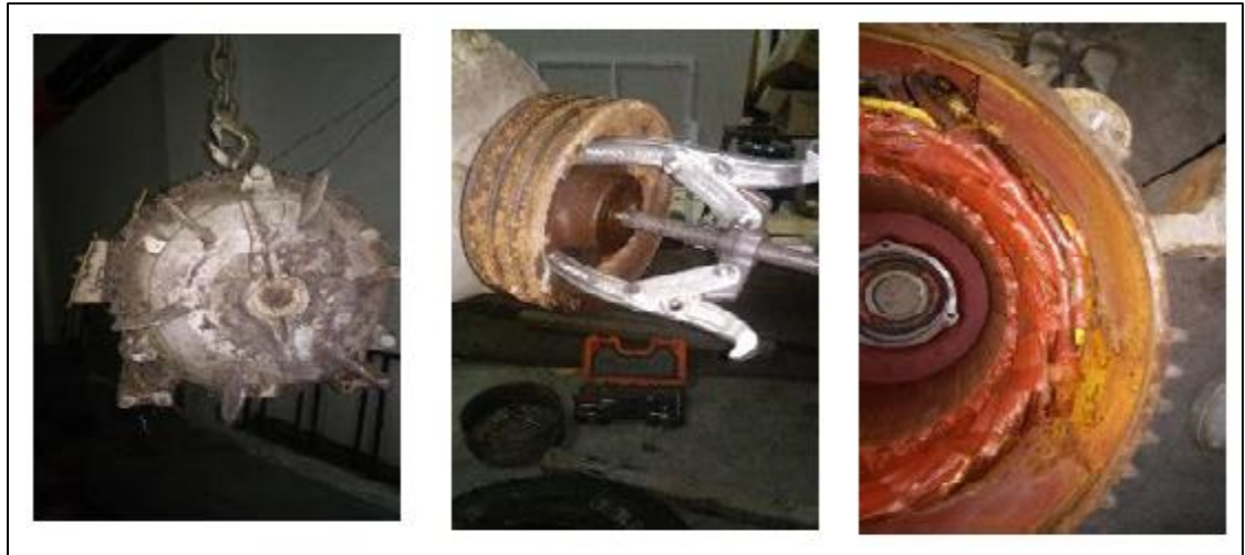
Figura 5.1-3. Se identifica óxido y humedad en escudos, y en bobinados del motor
