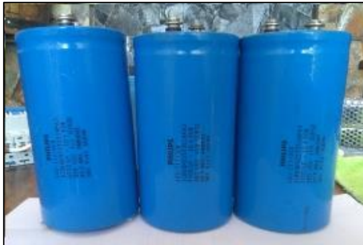
Figura 4.5. Capacitores de 3700uF
