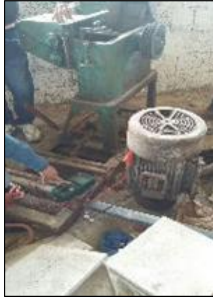
Figura 5.1- 1. Pruebas de aislamiento del motor in situ
