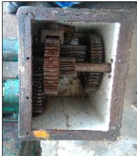
Figura 5.1-3 Residuos de aceite degradado en caja de transmisión
