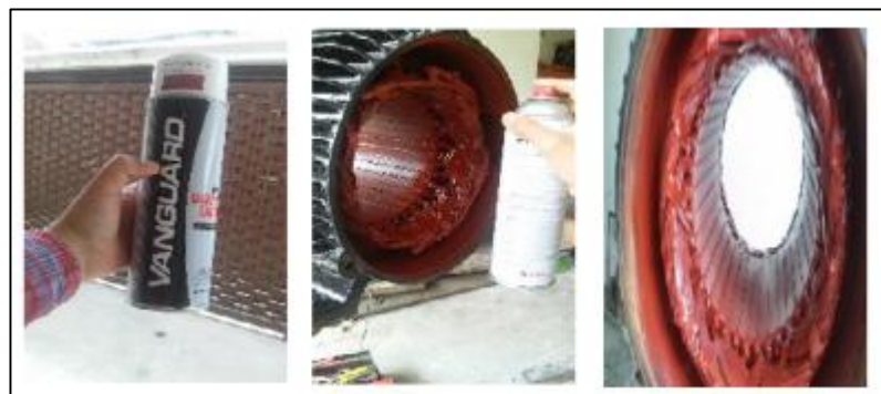
Figura 5.1-13. Barnizado dieléctrico luego de secado en el horno
