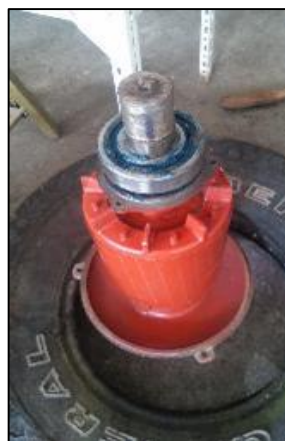
Figura 5.1-15. Cambio de cojinetes de las puntas
