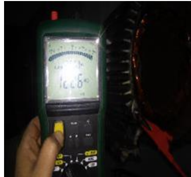
Figura 5.1-14. Recuperación de aislamiento en bobinados de motor
