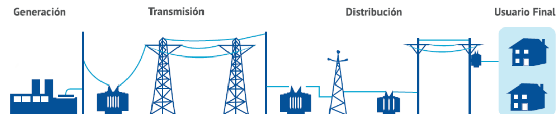
Figura 3.1. Estructura de un sistema de potencia típico.
