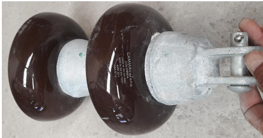
Figura 2.8 Aislador tipo campana. Fuente: CNEL EP Bolívar
