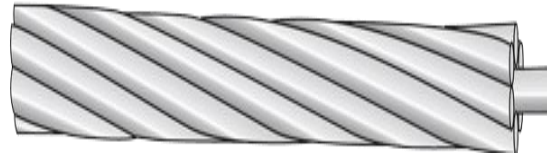
Figura 2.4 Conductor desnudo de Al. Fuente: (MEER, 2011)
