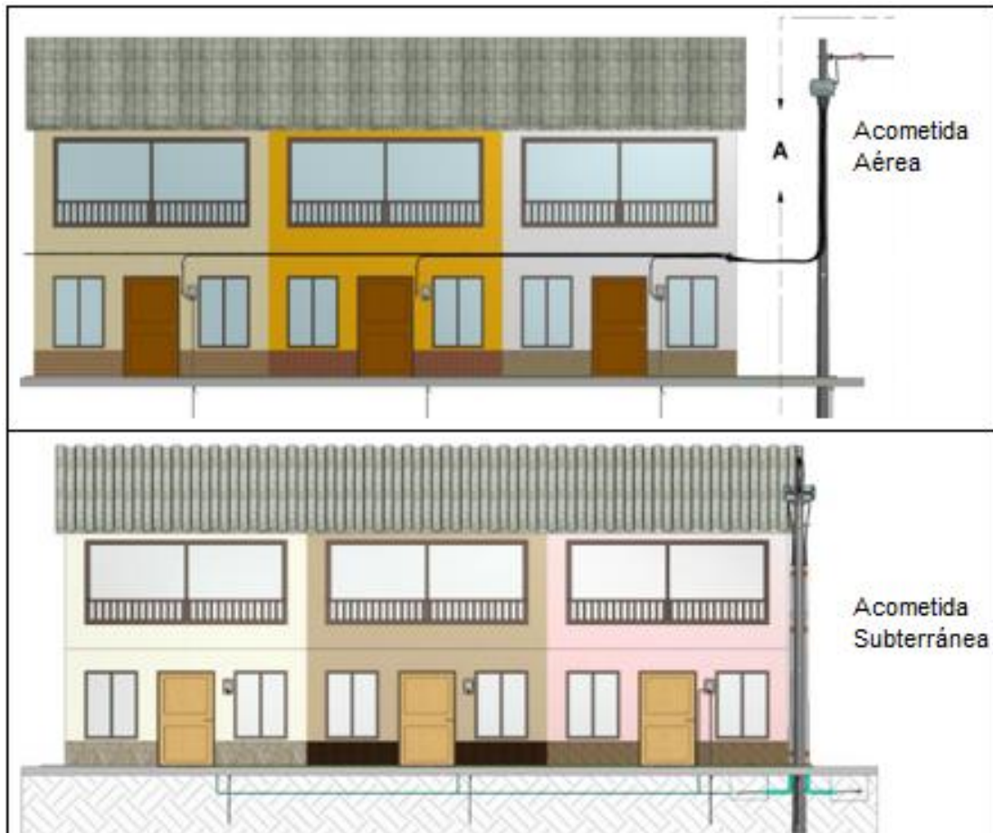
Figura 2. Acometidas aérea y subterránea. [5]
