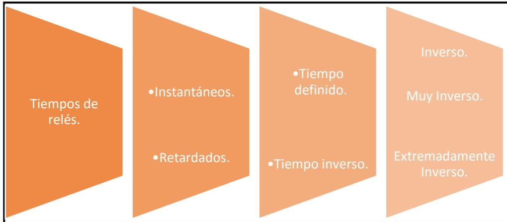
Figura 2.7 Tipos de relés según su característica de tiempo de operación. (Fuente autores).
