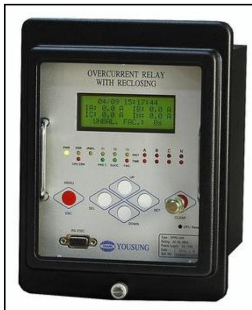
Figura 2.6 Relé digital de Sobrecorriente. [13]
