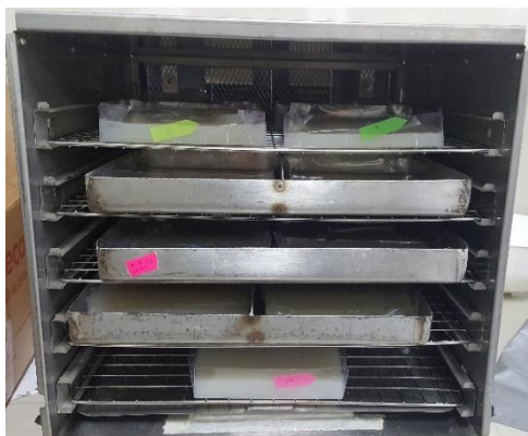
Fotografía 18. Secado de la grenetina en el horno secador - Obtención de grenetina mediante el método químico Tomada el 04/04/2018 – Laboratorio de Cárnicos de la Universidad de Cuenca
