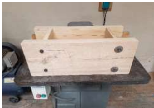
Figura 5: Tapialera utilizada para ensayos, Ecuador. Fuente: Propia
