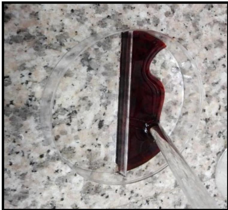
*Caja bipetri con muestra con adición de KI 3N e indicador*
