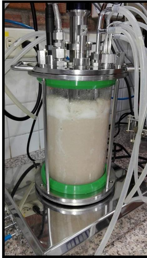
*Birreactor BiotronGX en funcionamiento*
