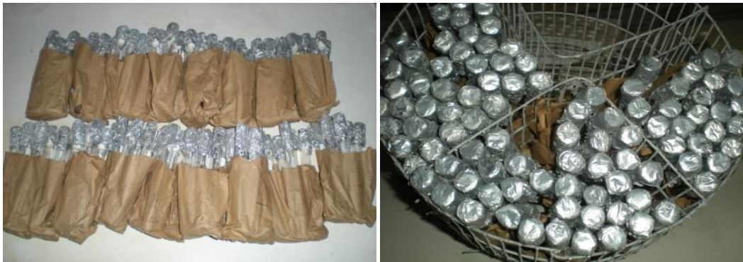
Fotografía 47 y 48: Preparado y colocación de los tubos de ensayos para la esterilización.
