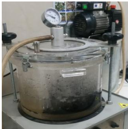
Ilustración 16. Proceso de extracción de vacíos de la mezcla.
