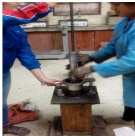
Ilustración 12. Compactación de la mezcla.
