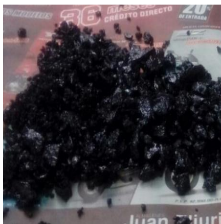
Ilustración 14. Material desmenuzado previo al ensayo.
