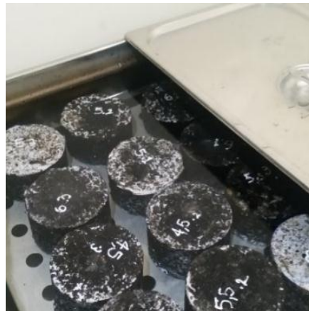
Ilustración 19. Saturación de las briquetas, agua a T=25^{\circ}C .
