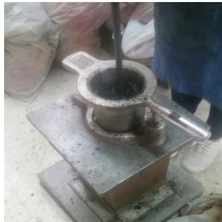
Ilustración 11. Varillado de la mezcla.
