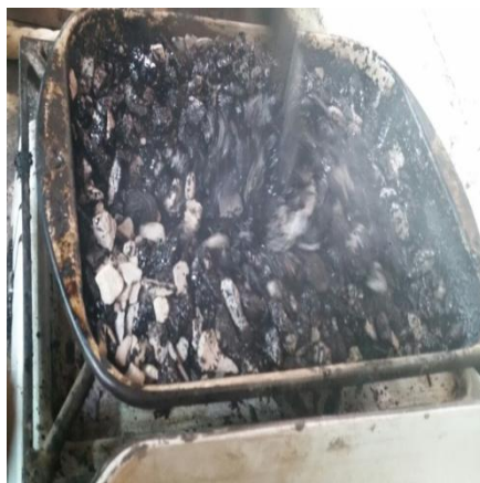
Ilustración 9. Mezcla en caliente de los agregados con el betún asfáltico.
