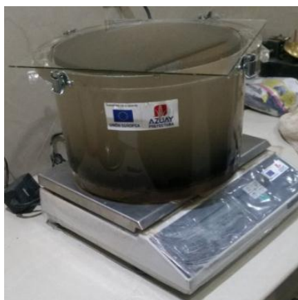
Ilustración 17. Pesaje de la muestra con el picnómetro lleno de agua.
