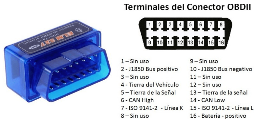
Figura 4.3: Escáner ELM327 y pines de conexión, Fuente: [14, Fig. 2]
