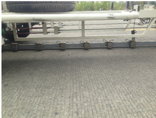
(c) Sensores de medición de deflexiones (Geófonos). Vista lateral.
