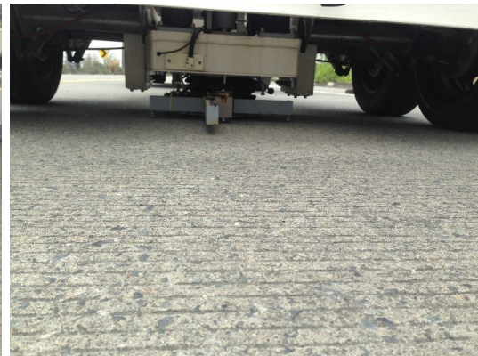
(d) Plato de carga asentado sobre el pavimento.
