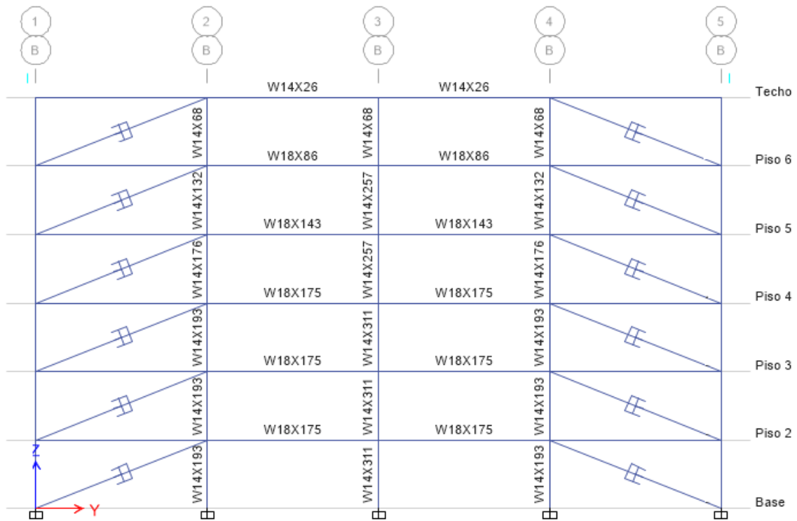
Figura 68 Elevación B y E - Análisis no lineal
