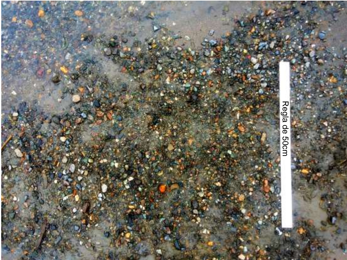
Figura 28: Fotografía del lecho del río Bulubulu, las partes con agua se excluyeron para el análisis posterior por el error que generan en el programa.
