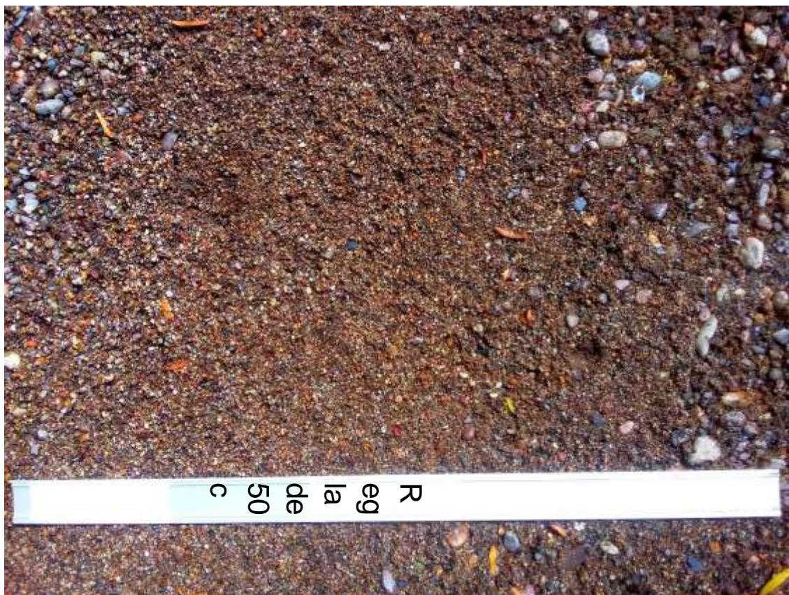
Figura 37: Fotografía del lecho del río Santa Bárbara para la segunda muestra, La imagen contiene en su mayoría arena para el análisis en casos extremos del programa Basegrain2.2.
