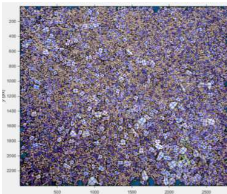
Figura 23: Imagen resultante del análisis del programa Basegrain2.2 a la fotografía del lecho del río Cochancay, Se tomó un área representativa de la fotografía anterior con poco contenido de tierra.
