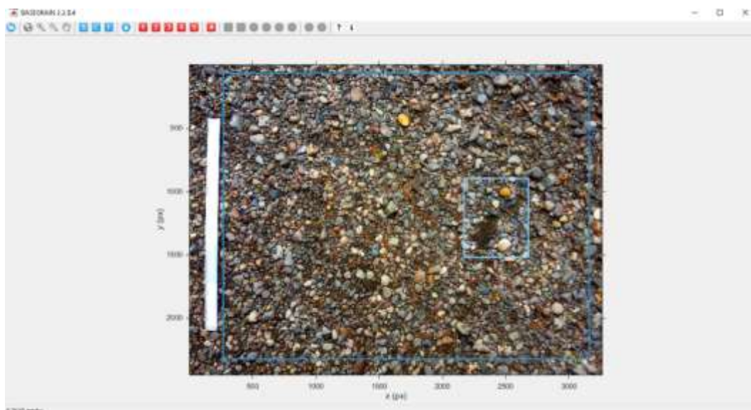
Figura 6: Interfaz del programa Basegrain2.2 que muestra la escala en mm/px (milímetros por pixel) en la esquina inferior izquierda, el recuadro azul grande encierra el área que va a ser analizada y el recuadro celeste pequeño muestra un área representativa para definir los parámetros en los siguientes pasos.
