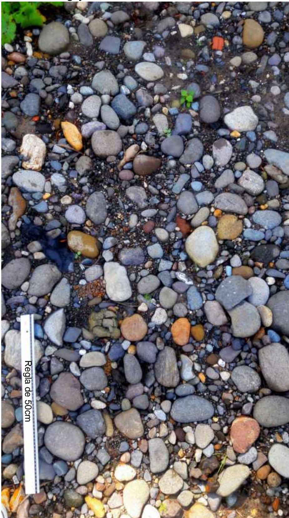
Figura 43: Fotografía del lecho del río Burgay, se observa la variedad de áridos y vegetación que perjudica a la precisión del análisis granulométrico.
