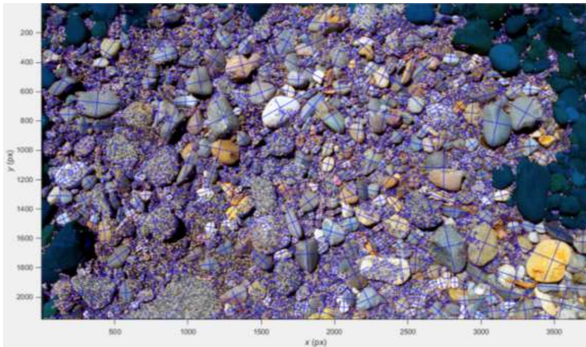
Figura 41: Imagen resultante del análisis del programa Basegrain2.2 a la fotografía del lecho del río Machángara, debido a la porosidad de algunas rocas, el programa las reconoce visualmente como un cumulo de arena.
