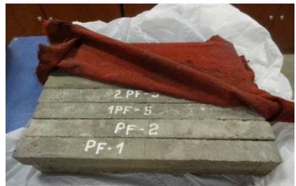
Ilustración N° 32: Probetas cubiertas con franela húmeda antes de ensayo a la flexión. Fuente: autor
