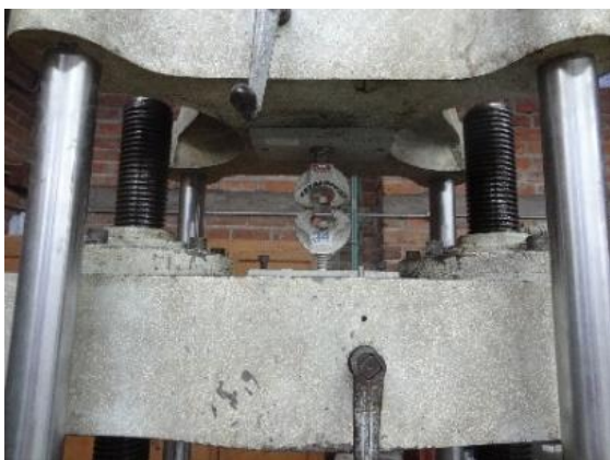
Ilustración N.º 41: Ensayo a la tracción de mortero con 20% de PET. Fuente: autor
