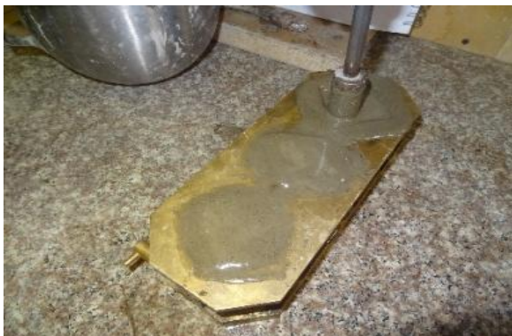
Ilustración N° 56: Colocación y compactación de mezcla en molde
