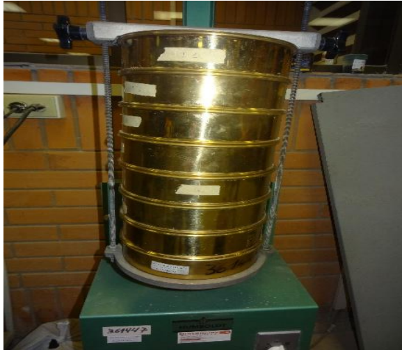
Ilustración N.º 12: Ensayo granulométrico en máquina Humboldt. Fuente: autor
