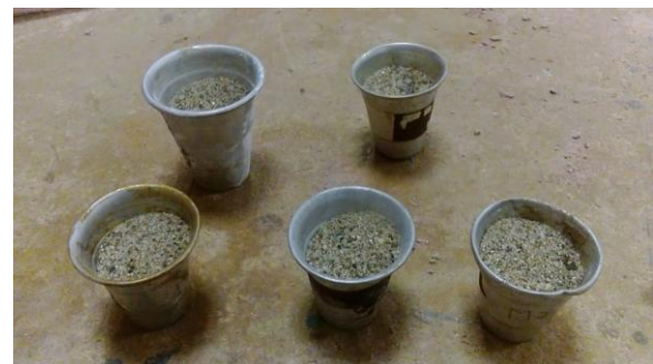
Ilustración N° 18: Arena en recipientes para ensayo de humedad en la arena
