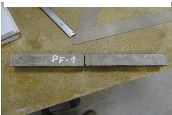
Ilustración N.º 35: Muestra fragmentada luego de aplicación de carga a flexión. Fuente: autor
