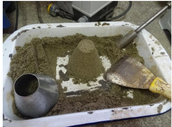
Ilustración N.º 15: Ensayo para determinar que la arena este Superficialmente Seca. Fuente: autor
