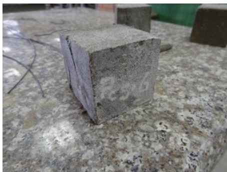
Ilustración N. ° 27: Cubo de mortero con 5% de PET, luego del ensayo de compresión. Fuente: autor
