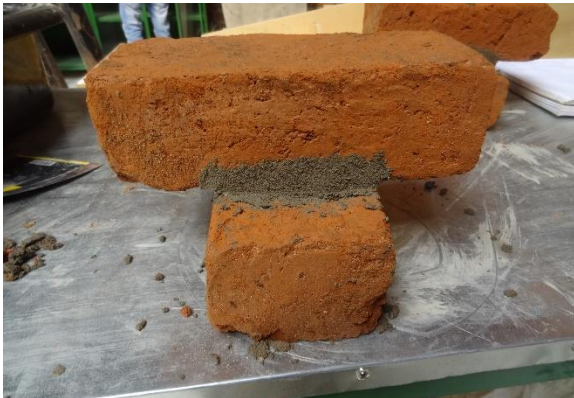
Ilustración N° 5: Pega de unidades de mampostería. Fuente: autor
