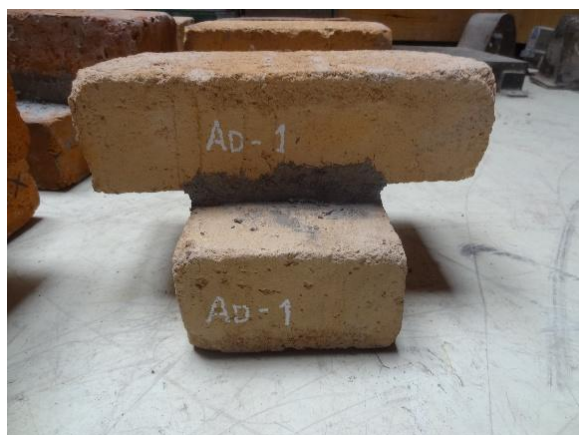
Ilustración N° 50: Especímenes pegados con mortero patrón en forma de cruz. Fuente: autor
