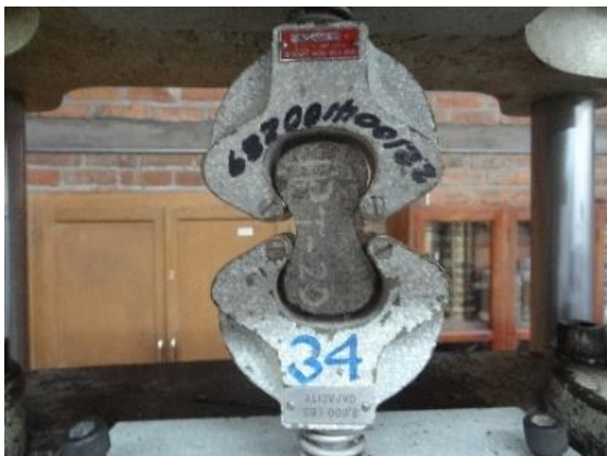
Ilustración N.º 40: Aplicación de carga en mortero en ensayo a tracción. Fuente: autor
