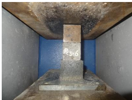
Ilustración N. ° 26: Ensayo a la compresión. Rotura en prensa de cubo de 50 mm de arista. Fuente: autor
