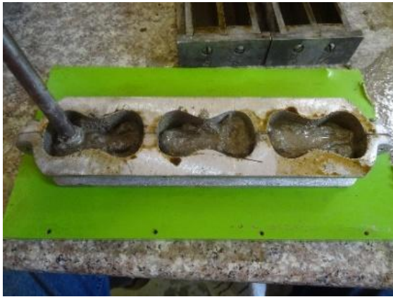
Ilustración N.º 39: Elaboración de probetas para tracción de morteros. Fuente: autor
