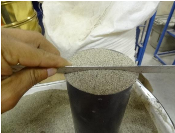
Ilustración N° 19: Llenado y rasanteo del recipiente con arena. Fuente: autor
