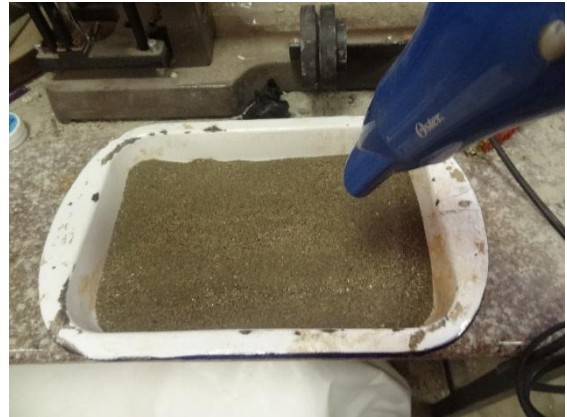
Ilustración N.º 14: Secado de arena con aire caliente. Fuente: autor
