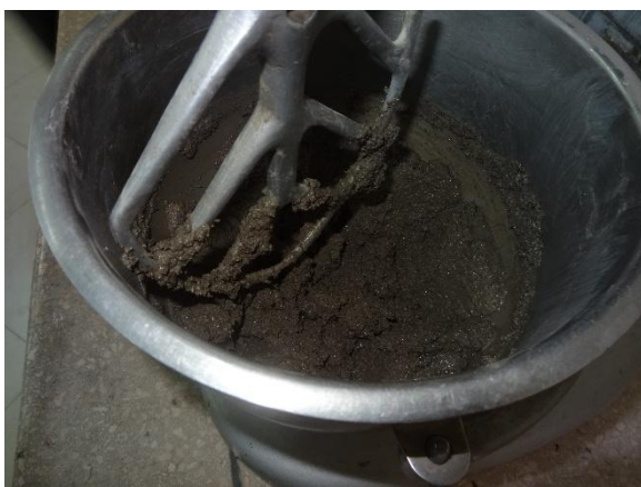
Ilustración N° 38: Batido de mortero a máquina. Fuente: autor
