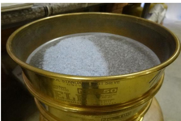
Ilustración N.º 13: Tamizado de material pétreo. Fuente: autor
