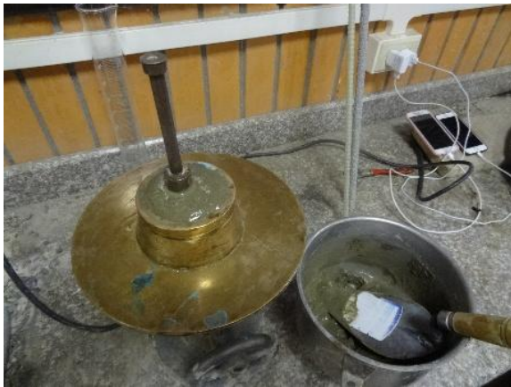
Ilustración 22: Ensayo de fluidez, compactación de la mezcla en el cono. Fuente: autor
