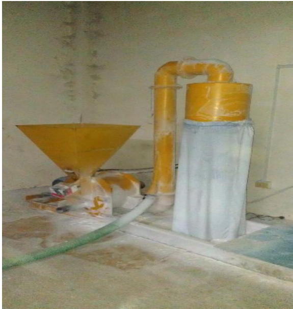
Ilustración N° 9: Molino artesanal para triturar botellas de PET de propiedad de la empresa Ferro Comercial Vera e Hijos. Fuente: autor
