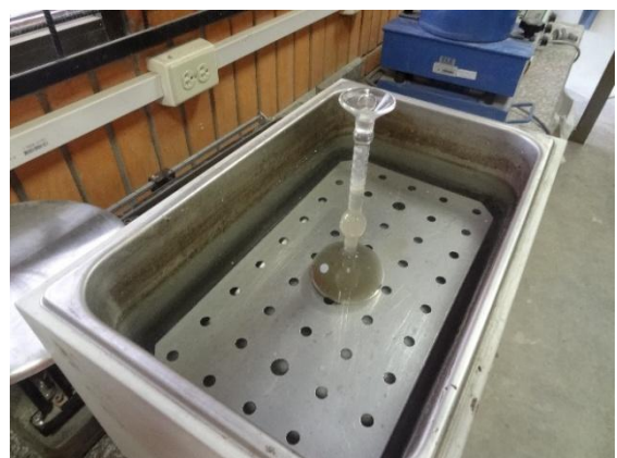
Ilustración N.º 16: Ensayo para alcanzar la temperatura de 23 \text{ °C} , en baño de María. Fuente: autor
