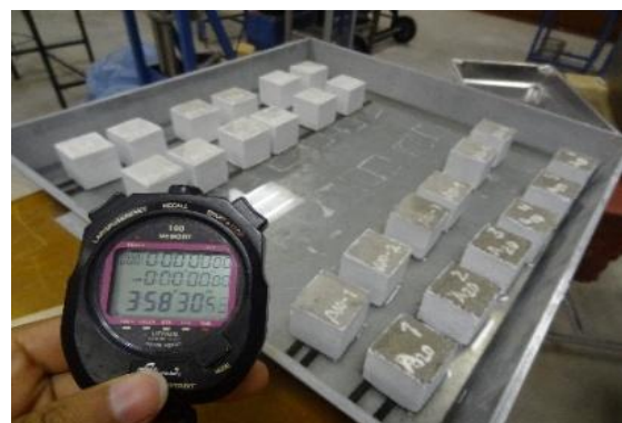
Ilustración N.º 62: Ensayo de absorción de acuerdo a tiempo de la norma y pesaje de probeta.
