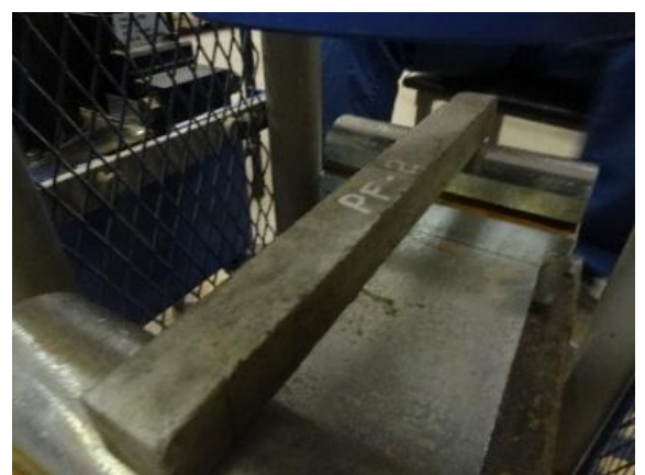
Ilustración N° 33: Colocación de la probeta en prensa antes de aplicar carga. Fuente: autor
