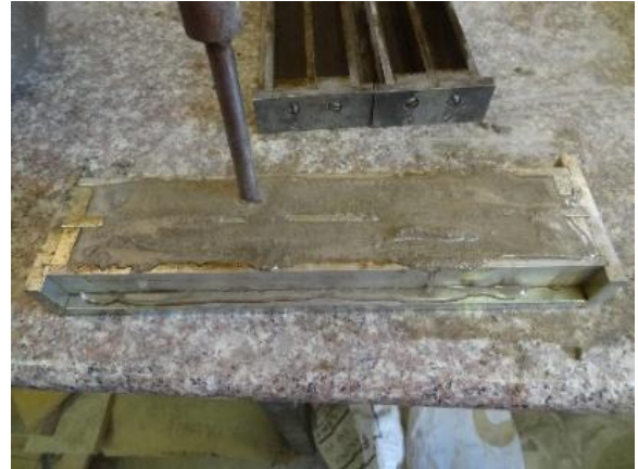
Ilustración N° 31: Preparación de especímenes para ensayo de resistencia a la flexión. Fuente: autor
