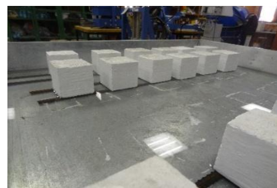
Ilustración N.º 61: Preparación y ambientación de las probetas para ensayo de absorción
