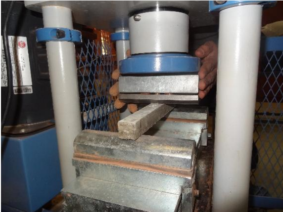
Ilustración N° 34: Aplicación de carga en el espécimen en ensayo a flexión. Fuente: autor
