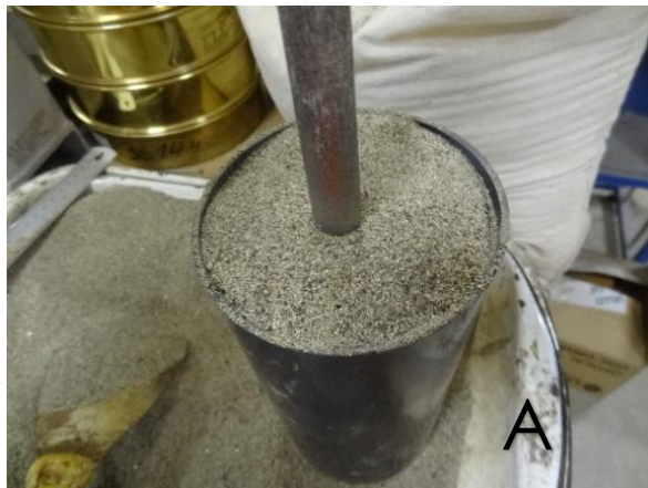
Ilustración N° 20: Compactado de la arena con varilla de punta redonda. Fuente: autor
