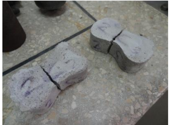
Ilustración N.º 42: Rotura de probetas luego de aplicación de carga a tracción. Fuente: autor
