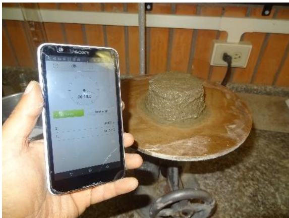
Ilustración N° 23: Ensayo de fluidez, inicio de la compactación en la mesa de flujo. Fuente: autor
