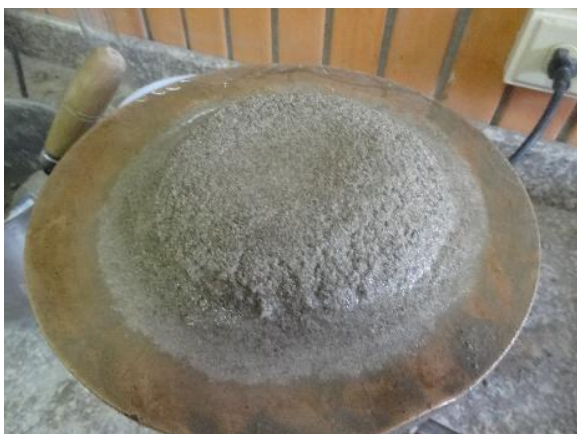
Ilustración N° 24: Mezcla luego del ensayo de compactación para determinar la fluidez en la pasta de mortero patrón y con contenido de PET. Fuente: autor
