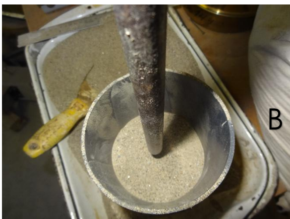
Ilustración 20: Compactado de arena en capas con varilla a una altura de 5 cm. Fuente: autor
