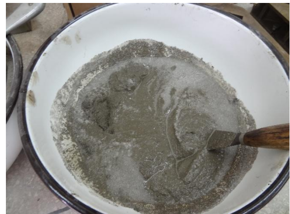
Ilustración N° 2: Mortero con adiciones de PET, para elaborar probetas. Fuente: autor
