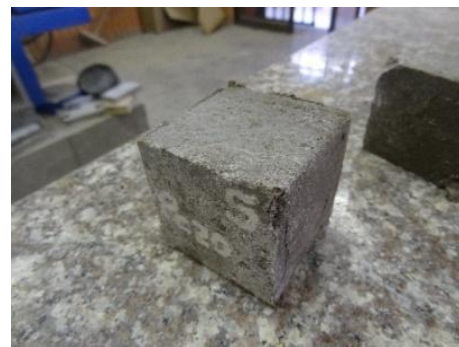
Ilustración N. ° 28: Cubo con 20% de PET. Ensayo de compresión. Fuente: autor
