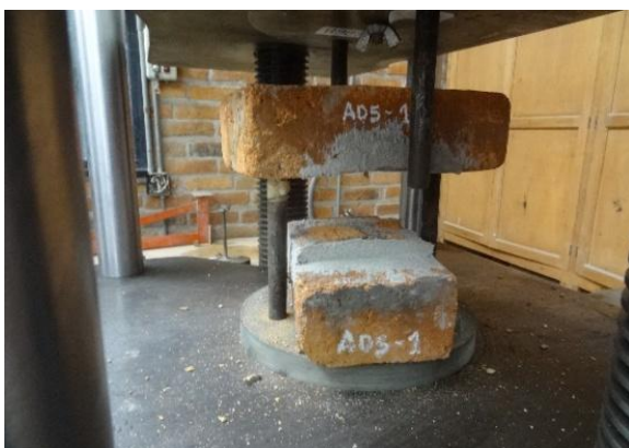
Ilustración N° 52: Desprendimiento de ladrillos en ensayo de adherencia. Fuente: autor
