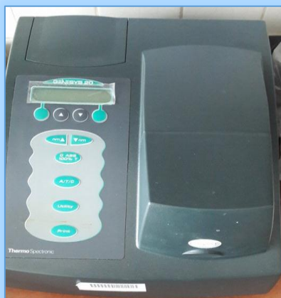
Figura 9. Espectrofotómetro Thermo Spectronic (GENESYS 20) empleado en la lectura de las absorbancias de las muestras.
