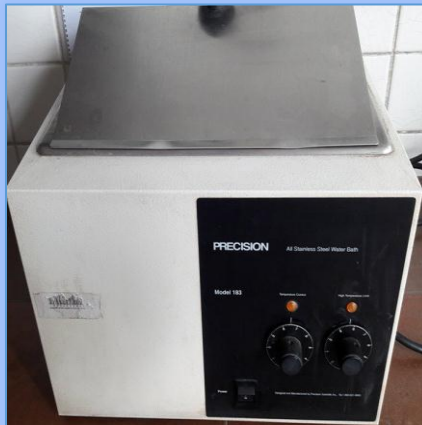
Figura 8. Baño María (PRECISION) Thermo Fisher: empleado en el proceso de valoración de la muestra.
