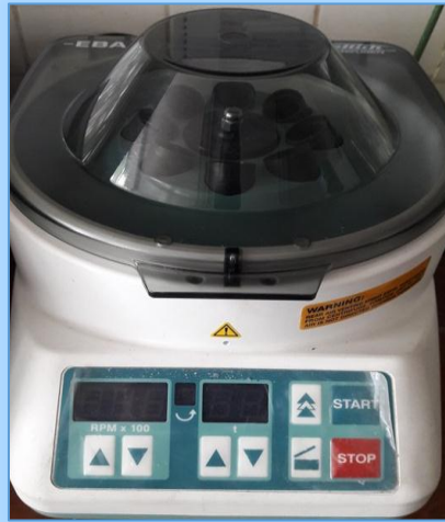
Figura 7. Centrifuga (EBA 20) para la obtención del filtrado de la muestra desproteinizada.
