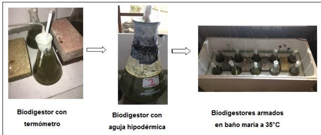
Figura 15. Montaje de los biodigestores
