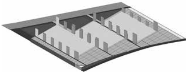
3. ESTRUCTURA DE HORMIGÓN: DIAFRAGMAS
