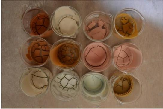
Figura 3-5. Muestras de pigmentos sometidos a secado en la estufa a  $105^{\circ}\text{C} \pm 5^{\circ}\text{C}$
