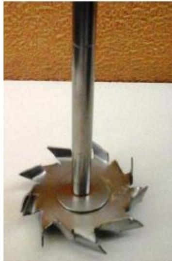
*Figura 3-2. Disco Cowles adaptado*
