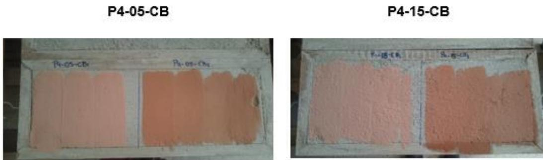
Figura 4-3. Aplicación de la pintura P4-CB con mínima y máxima concentración de aglutinante a diferentes viscosidades
