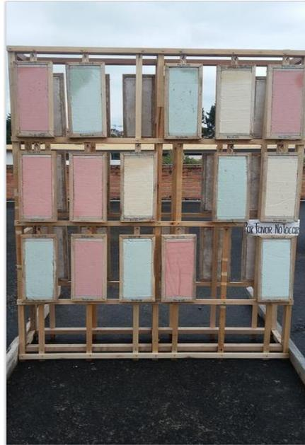
Figura 3-10. Soportes expuestos a condiciones ambientales de intemperismo
