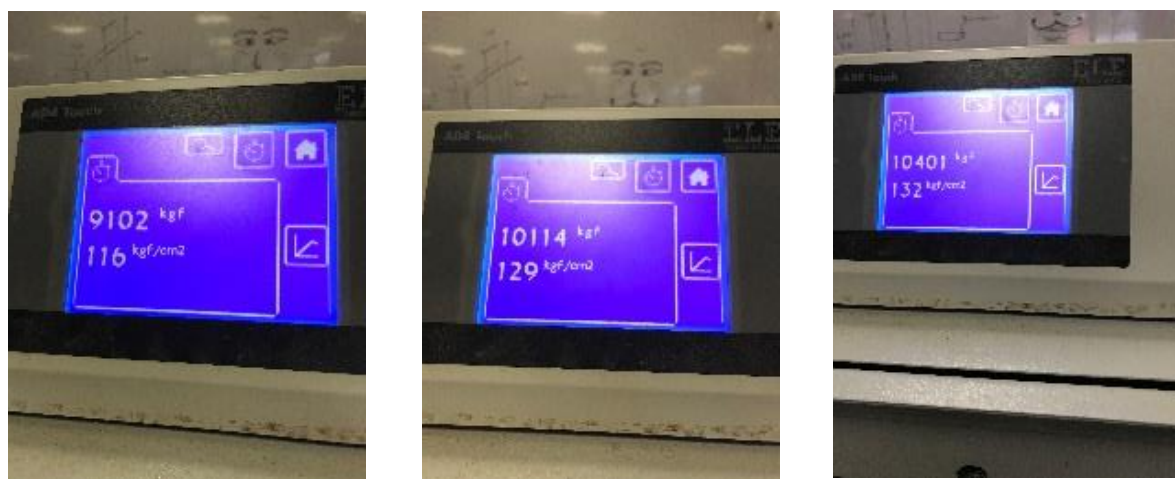
Figura 39. Ejemplos de Esfuerzos de carga R en BTC ensayados a compresión. (Autor, 2017).
