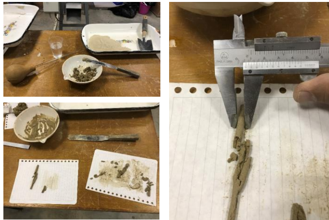
Figura 37. Ensayo límite plástico. (Autor, 2017)
