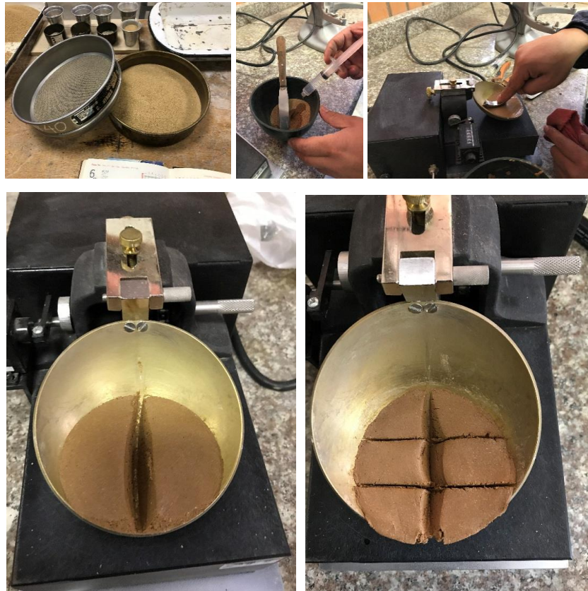
Figura 22. Ensayo Máquina de Casagrande. (Das, 1985)
