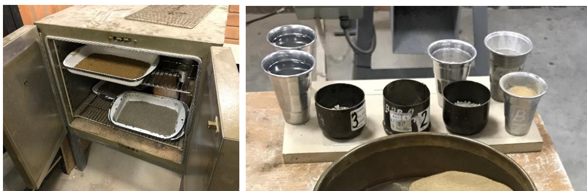
Figura 20. Ensayo para contenido de humedad de suelo. Fuente: (Autor. 2017)
