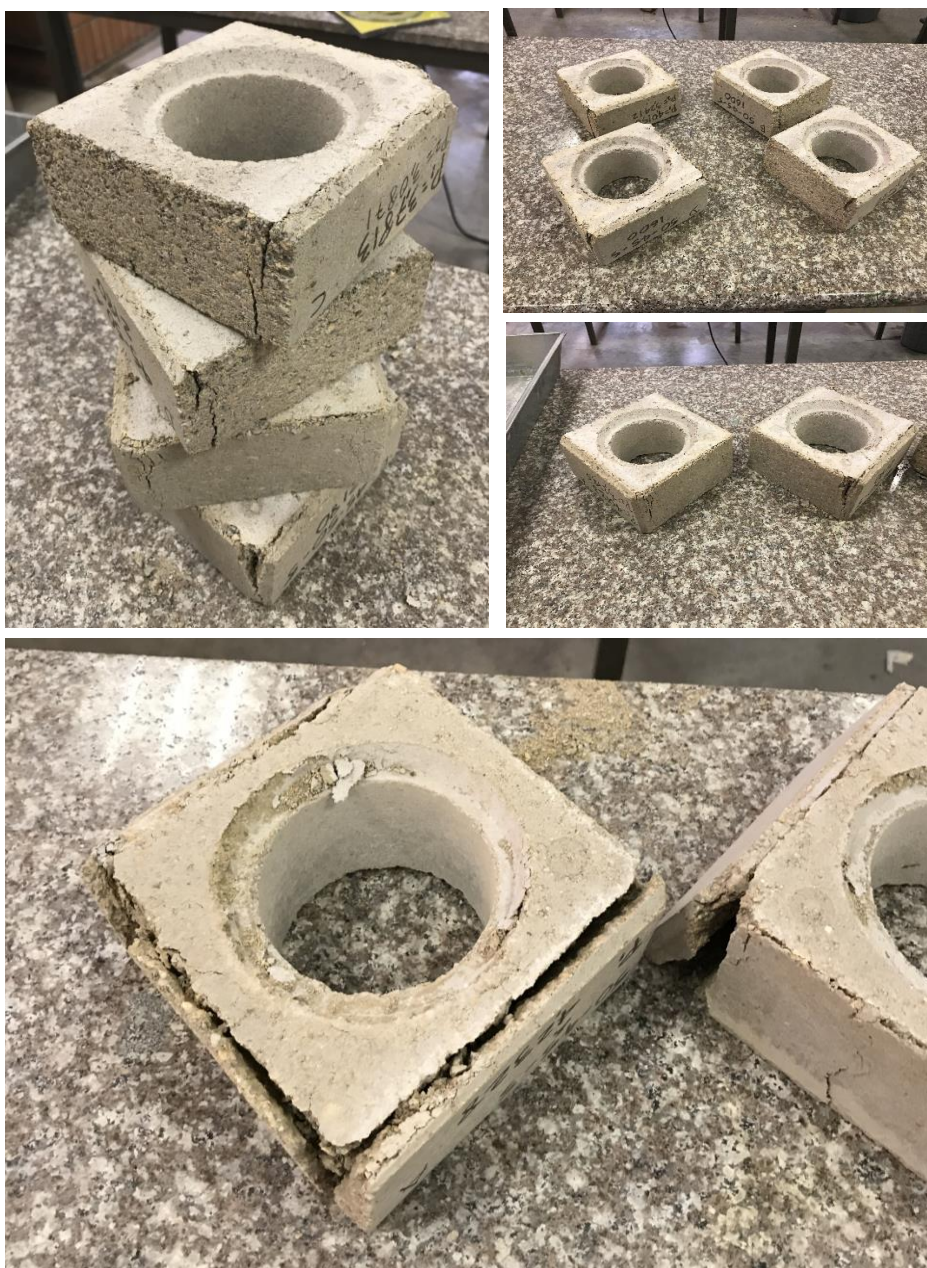
Figura 40. Patrón de rotura en BTC ensayados a compresión. (Autor, 2017)
