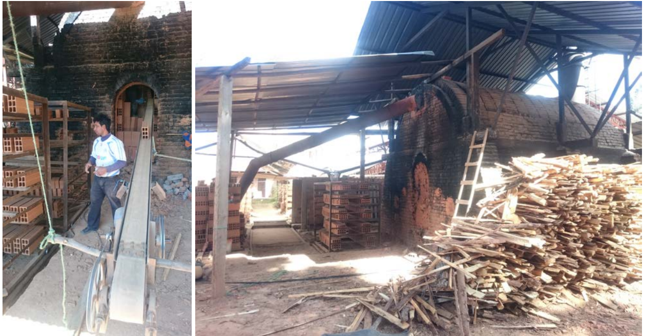
Figura No. 11 Llenado del horno (izquierda). Horno de tiro invertido y tubería de extracción de aire caliente para el secadero (derecha). Fuente: Autor
