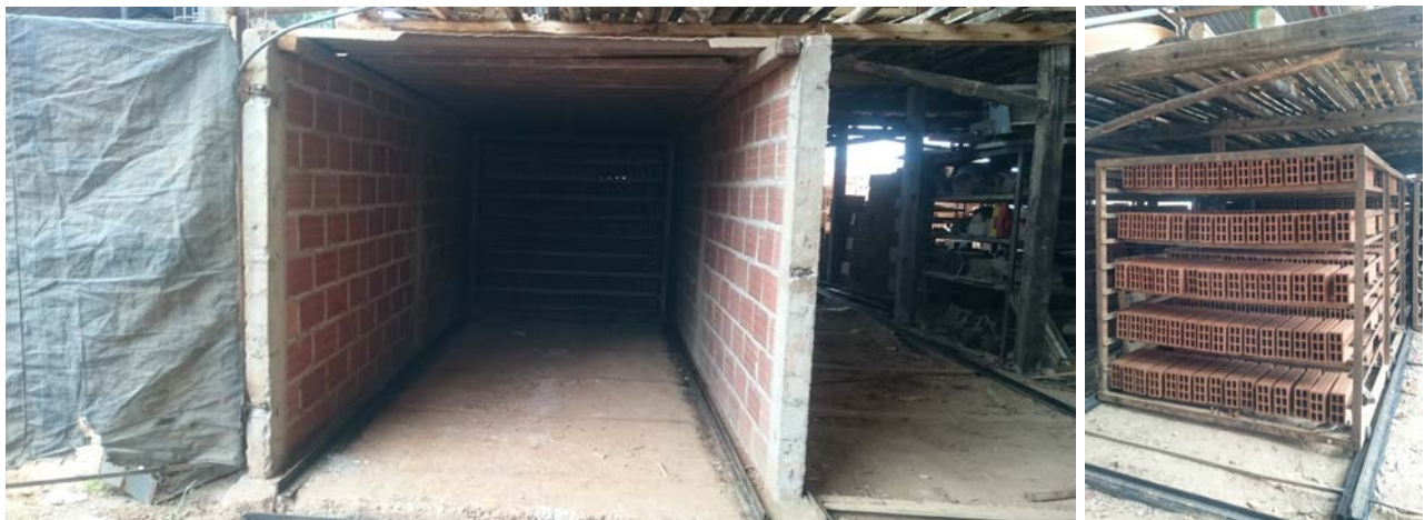
Figura No. 9 Entrada del secadero (izquierda). Carros transportadores (derecha). Fuente: Autor
