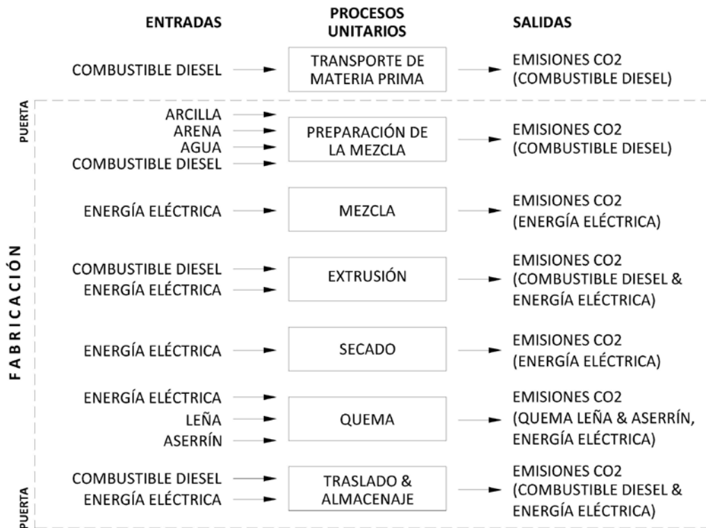
Figura No. 13 Diagrama de procesos unitarios y entradas y salidas de fabricación del ladrillo semi-mecanizado tochano. Elaboración: Autor
