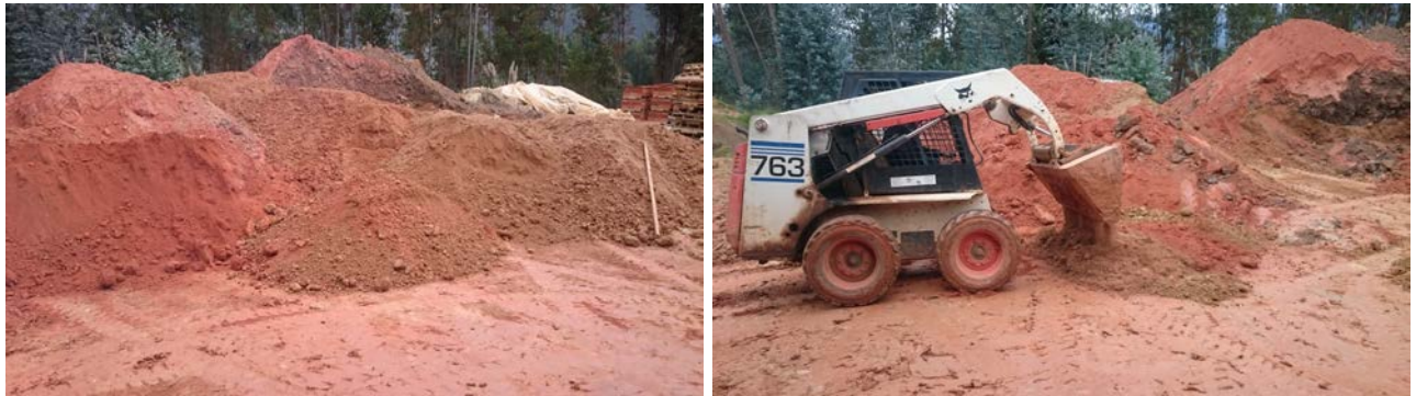
Figura No. 6 Materia prima en lugar de almacenaje (izquierda). Preparación de la mezcla de arcilla (derecha). Fuente: Autor
