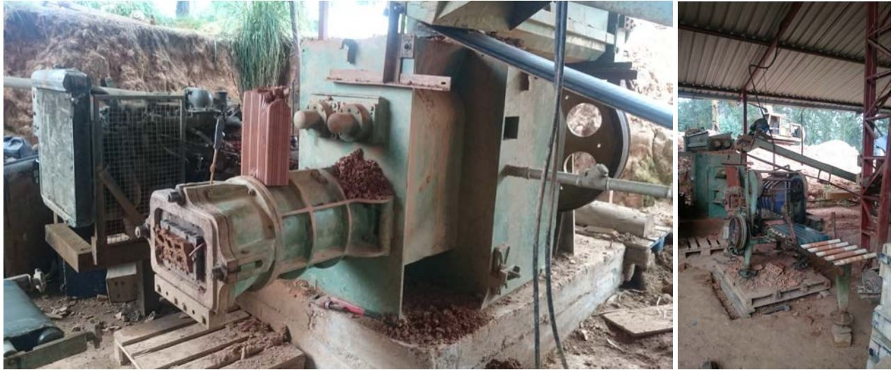
Figura No. 8 Extrusora de la fábrica en estudio (izquierda). Cortadora de ladrillos (derecha). Fuente: Autor
