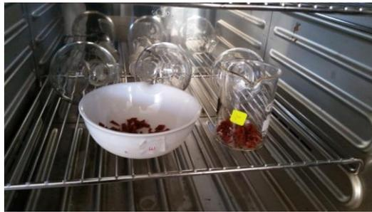
**Fotografía 17. Proceso de determinación de la humedad del chorizo**
