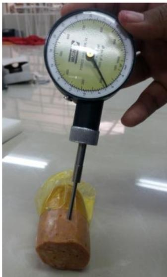
**Fotografía 19. Determinación de la dureza del chorizo**
