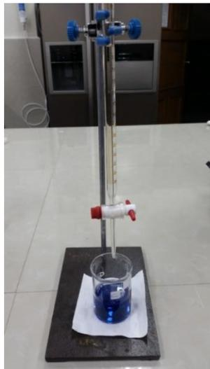
**Fotografía 22. Normalización del tiosulfato de sodio**
