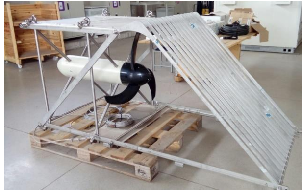
Figura 3.17 Hidrocinética de la microrred del laboratorio de Balzay
