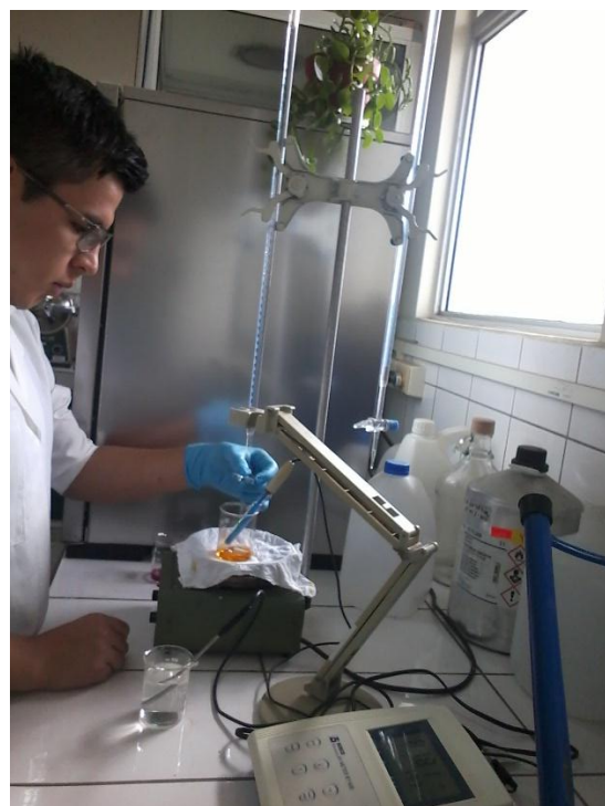
Fotografía N°11: Titulación para determinación de alcalinidad total.
