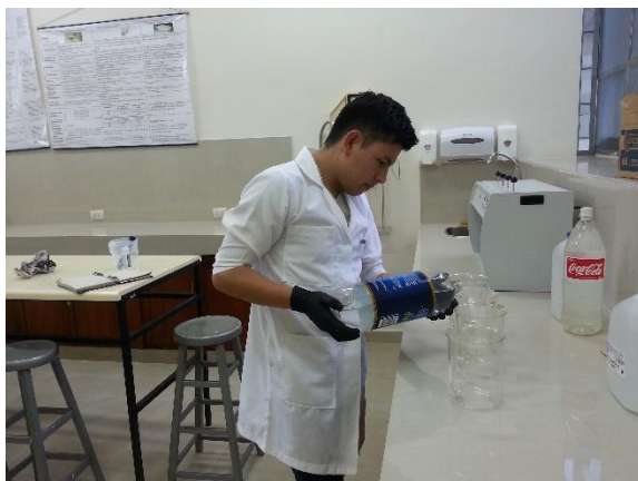
Fotografía N°62: Prueba de Jarras en Equipo Orbeco Helligue para 4 litros.
