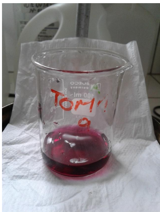
Fotografía N°14: Determinación de dureza total antes del viraje.
