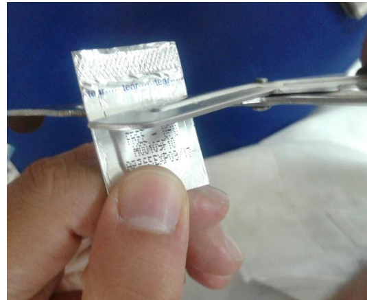
Fotografía N°27: Modo de corte de sobre HACH.
