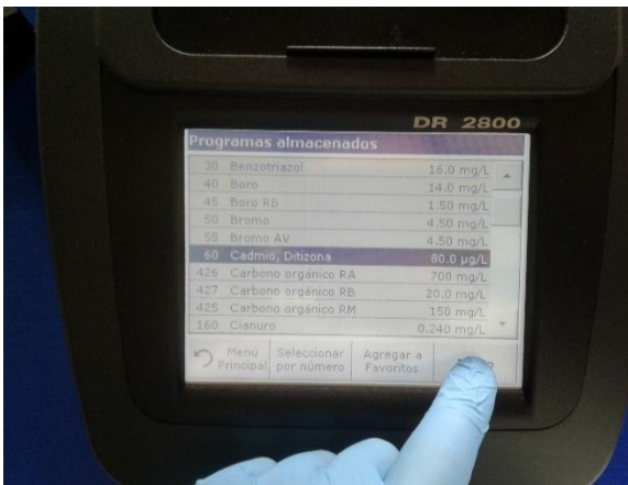
Fotografía N°44: Selección del programa y medición de cadmio por espectrofotometría.
