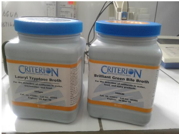
Fotografía N°46: Medio de caldo de Lauril Triptosa para coliformes totales y Medio de caldo de Verde Brillante para coliformes fecales.
