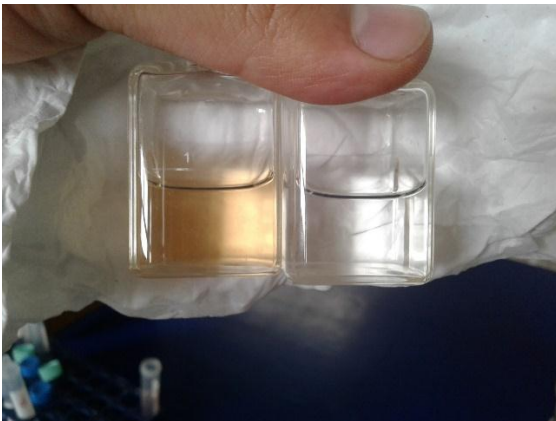
Fotografía N°34: Comparación de color entre blanco y muestra con reactivo HACH para nitratos.
