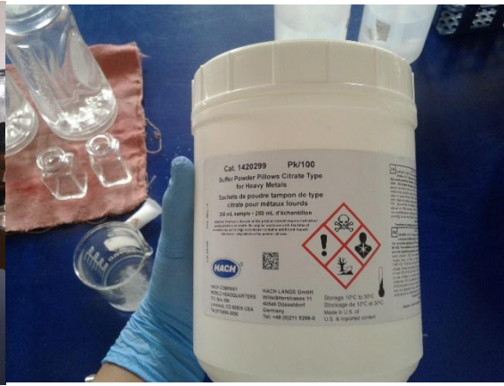
Fotografía N°43: Reactivo citrato para metales pesados en determinación de cadmio.
