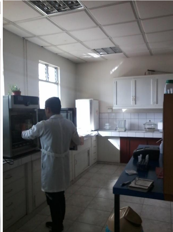
Fotografía N°61: Incubación de muestras microbiológicas en estufa a 37°C.
