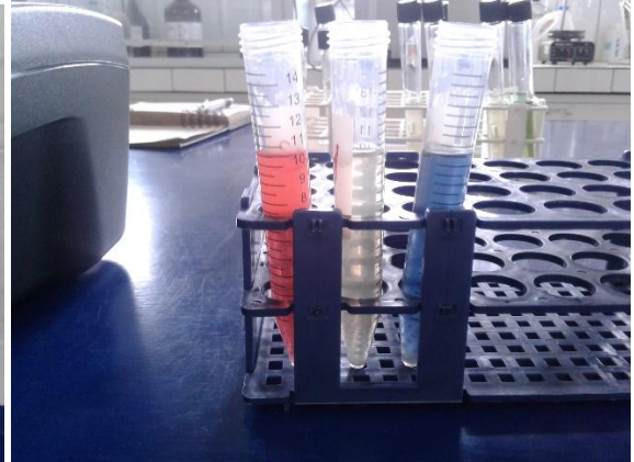
Fotografía N°31: Coloración de muestras luego de adición del reactivo HACH.
