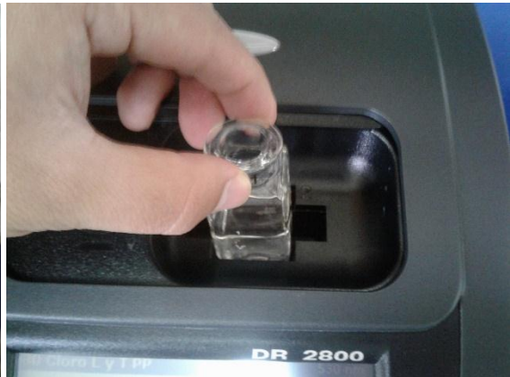
Fotografía N°35: Momento de insertar la cubeta en la celda de medición.
