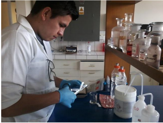
Fotografía N°40: Preparación de muestra en determinación de cadmio por el método de ditizona.
