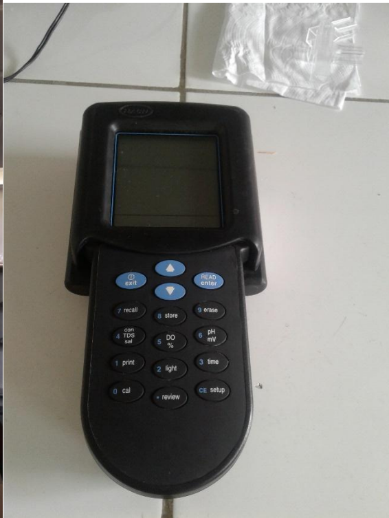
Fotografía N°21: Conductímetro HACH SENSIÓN 5 con electrodo de 1M.
