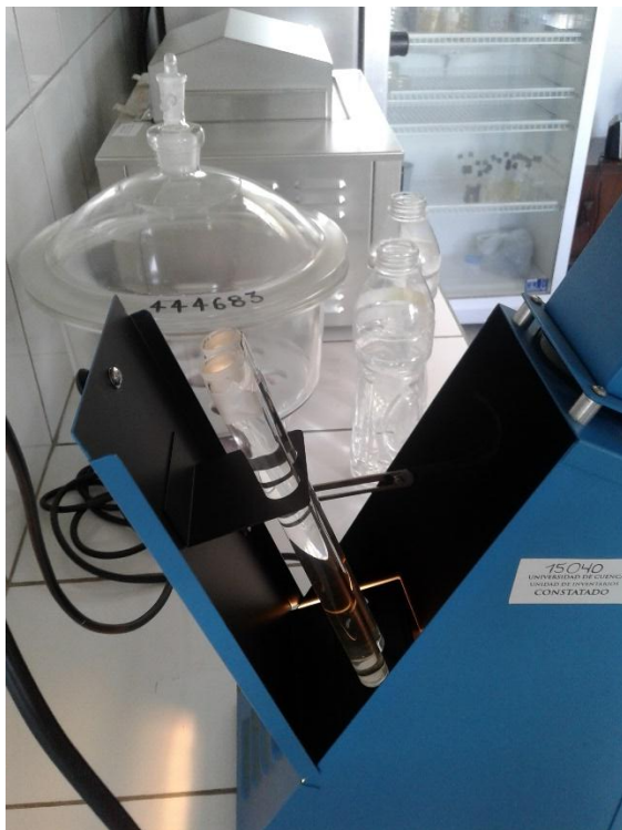
Fotografía N°18: Disposición de tubos Nessler con muestra en quipo de colorimetría.
