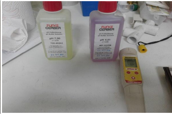
Fotografía N°5: Calibración de pH- metro con soluciones buffer.
