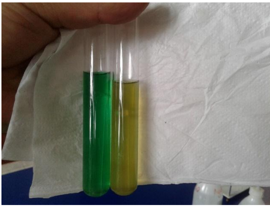
Fotografía N°56: (Fase confirmatoria) Comparación de actividad positiva microbiológica para coliformes fecales.
