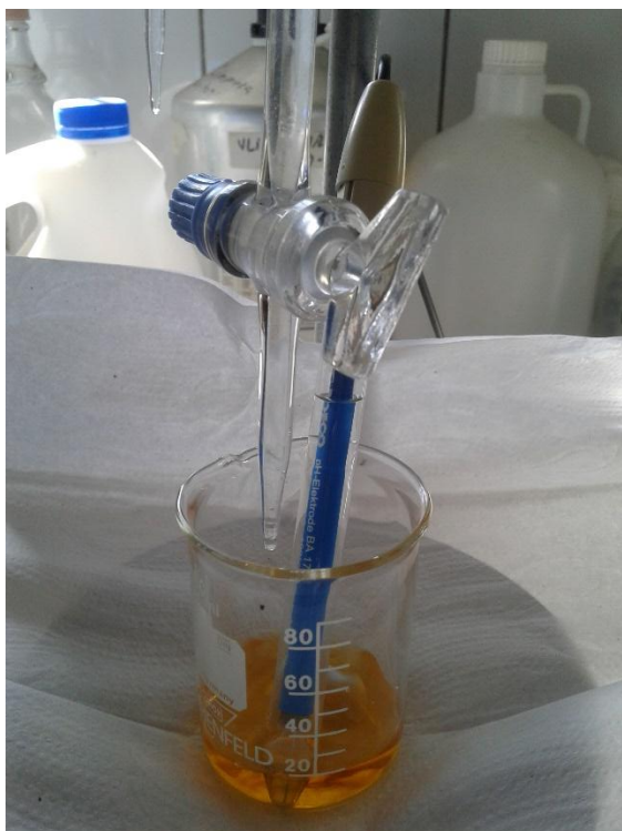
Fotografía N°12: Determinación de alcalinidad asistido con pH- metro digital BOECO BT- 600
