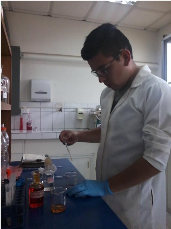
Fotografía N°10: Preparación de muestras para determinación de alcalinidad total.
