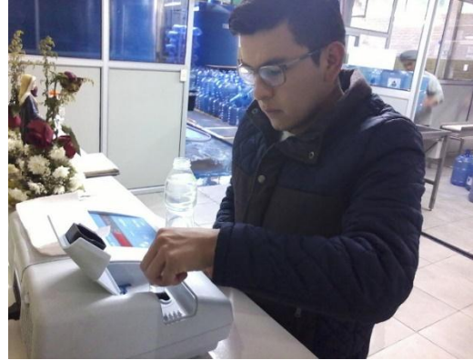
Fotografía N°9: Lectura de turbidez en equipo.
