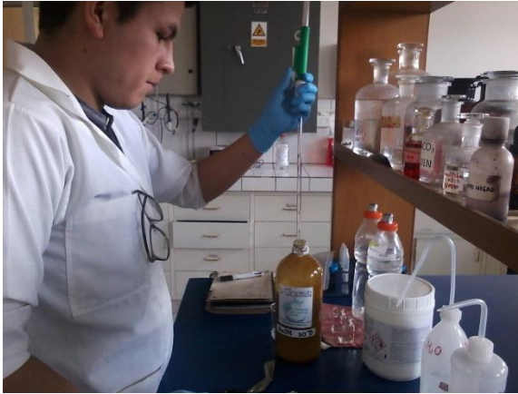
Fotografía N°42: Preparación de muestra en determinación de cadmio por el método de ditizona.
