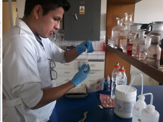
Fotografía N°41: Preparación de muestra en determinación de cadmio por el método de ditizona.
