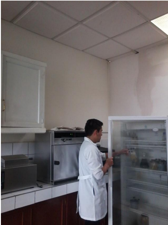
Fotografía N°60: Almacenamiento y refrigeración a 6°C de tubos con caldo de cultivo y cajas Petri sin inocular.
