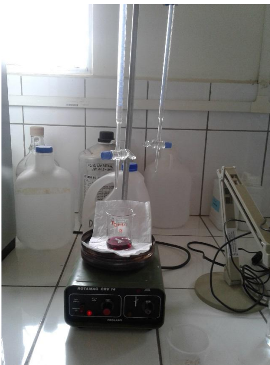
Fotografía N°13: Titulación en la determinación de dureza total.
