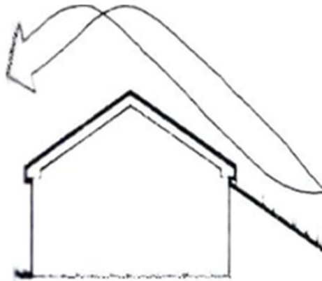
Figura 13: Talud que entierra la fachada, guiando al viento por la cubierta.
