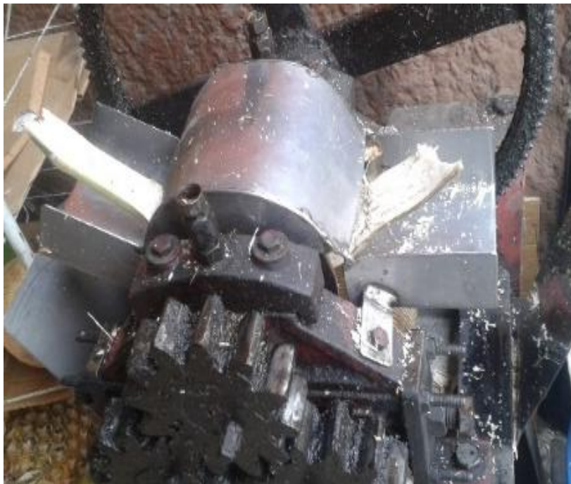
Figura 11 Trapiche: Obtención del Bagazo de Caña
