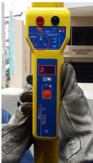
Figura 3.12. Resultados (fase y ángulo de desfase) de uno de los conductores de alimentación de un cliente importante.
