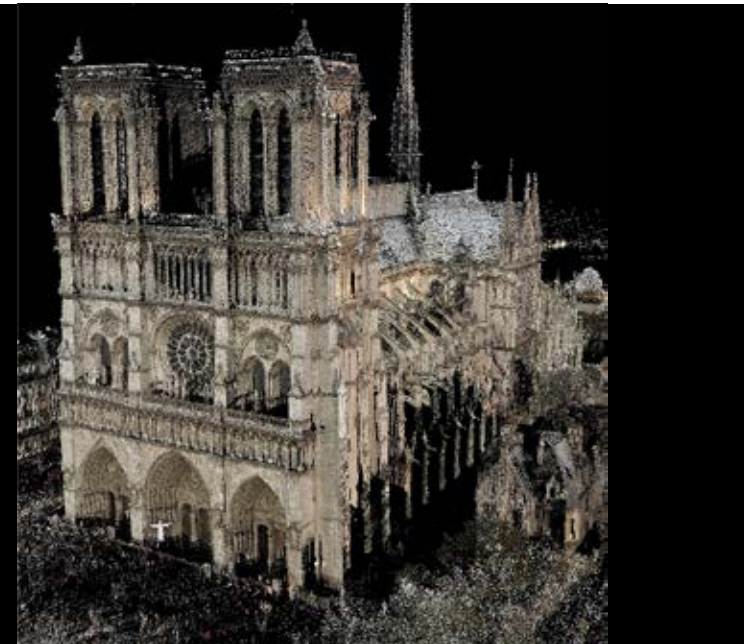
Figura 15: Creación de nube de puntos de la Catedral de Notre-Dame, a partir de levantamientos con 3D Laser Escáner realizado por Andrew Tallon. Fuente: Rachel Hartigan Shea, Historian Uses Lasers to Unlock Mysteries of Gothic Cathedrals . National Geographic, 2015
