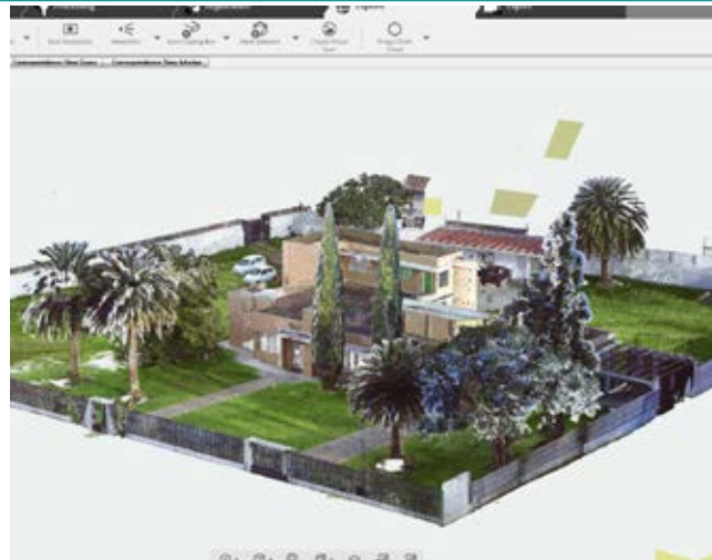
Figura 71: Nube de puntos completa. Fuente: Autores, 2017
