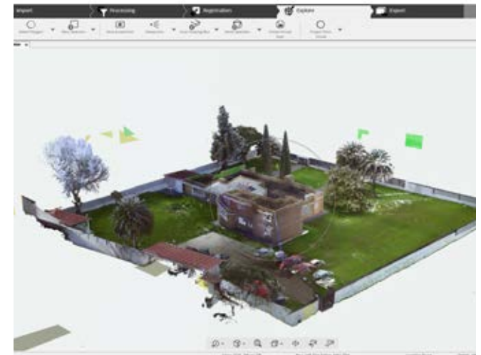
Figura 66: Depuración de nube de puntos exterior. Fuente: Autores, 2017
