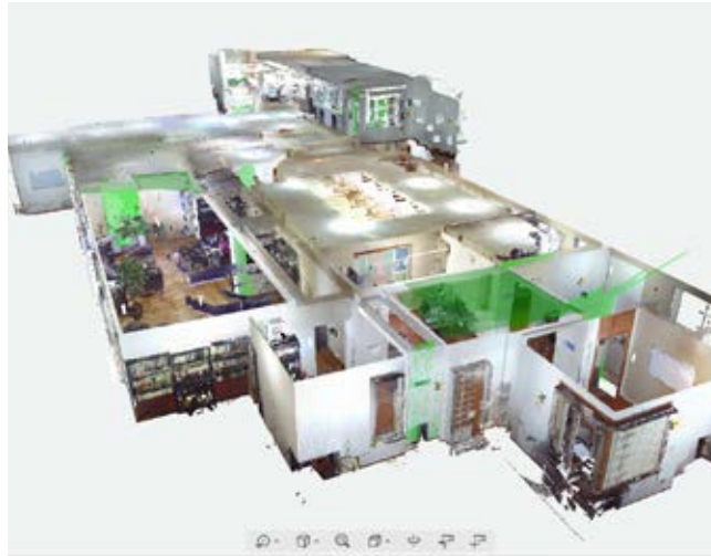
Figura 67: Visualización inicial de escaneos registrados para proyecto interior. Fuente: Autores, 2017
