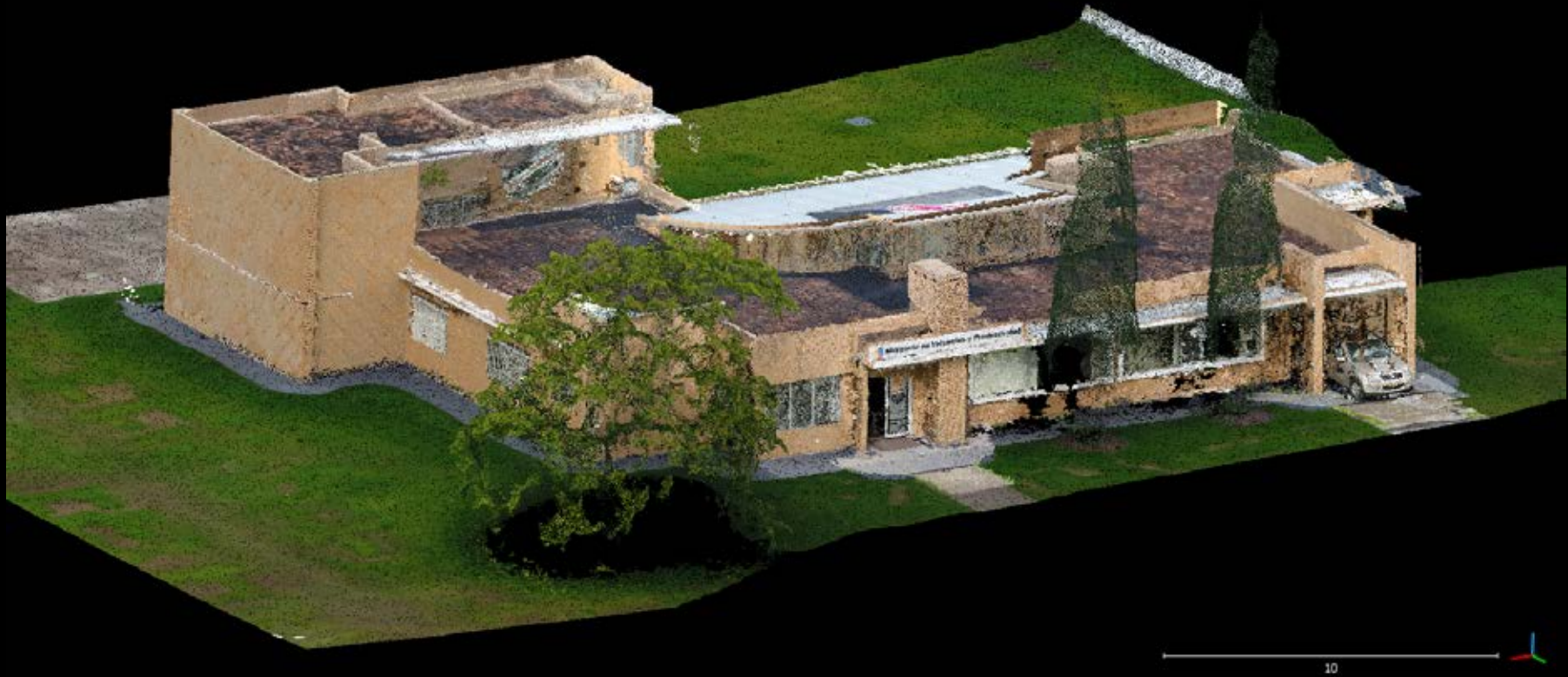
Figura 115: Resultado del modelo final de la Casa Peña a partir de la complementación de técnicas digitales: estereofotogrametría y fotogrametría. Fuente: Autores, 2017
