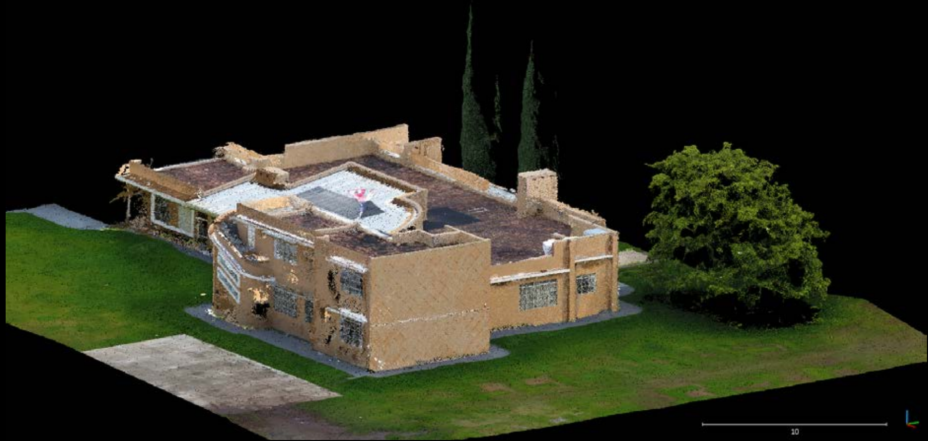
Figura 116: Resultado final de la Casa Peña a partir de la complementación de técnicas digitales: estereofotogrametría y fotogrametría. Fuente: Autores, 2017
