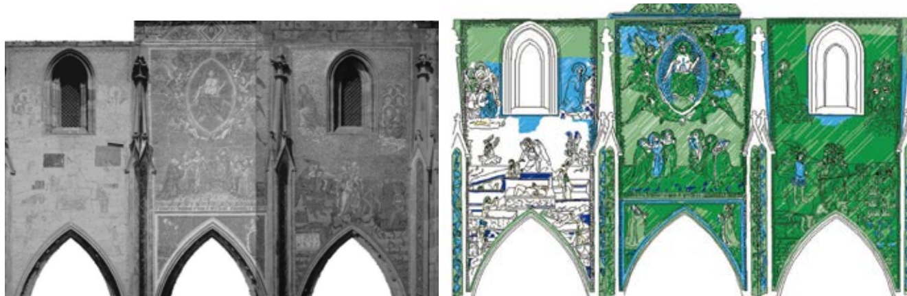
Figura 1: Técnicas Análogas / Boceto a mano que representa niveles de corrosión Fuente: Eppich R, 2007, Illustrated Examples, RECORDIM
