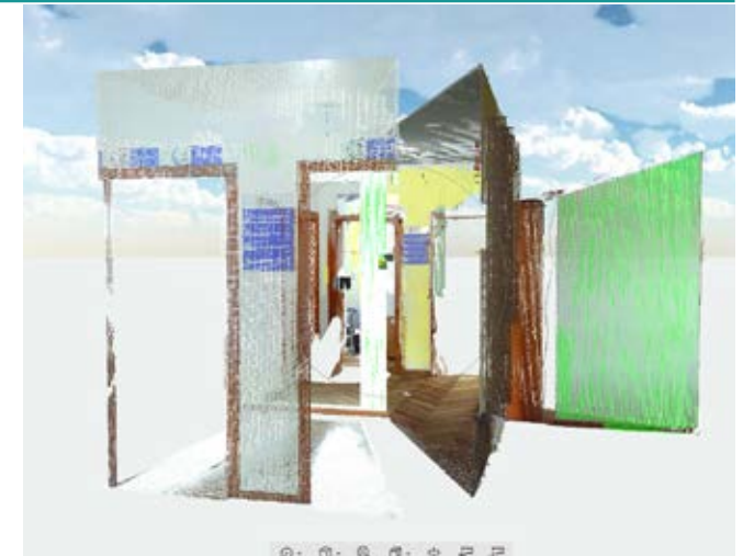
Figura 68: Depuración de escaneo interior por presencia de espejo. Fuente: Autores, 2017
