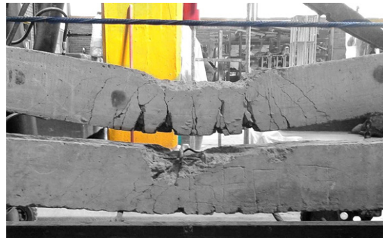
Figura 239: Columna sometida a esfuerzos cortantes.
