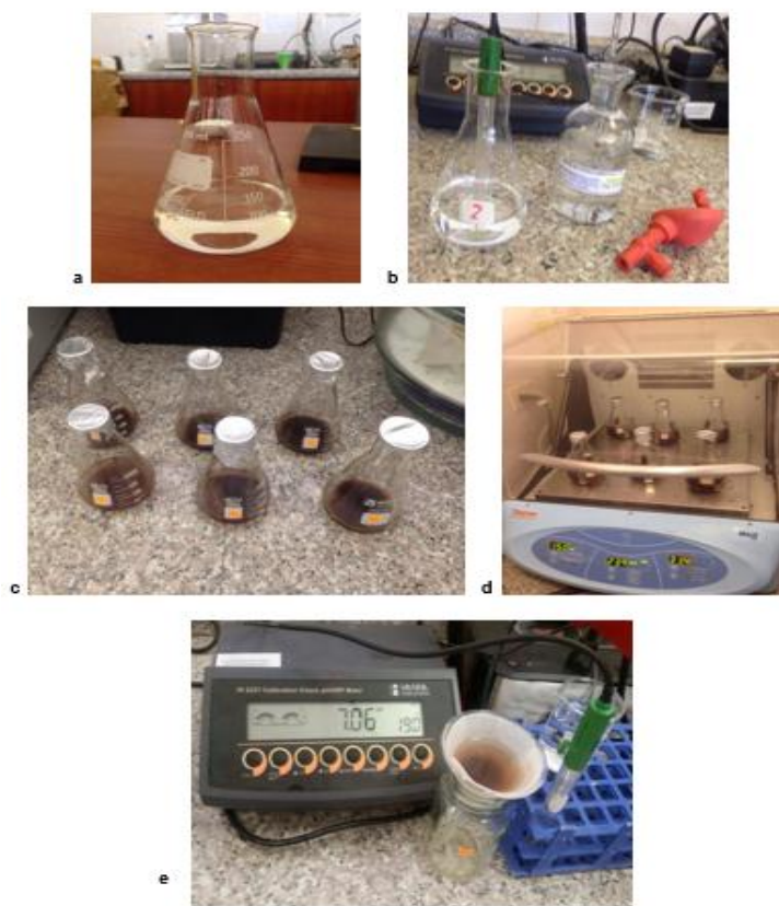
Figura 2. Proceso para determinar el punto de carga cero
