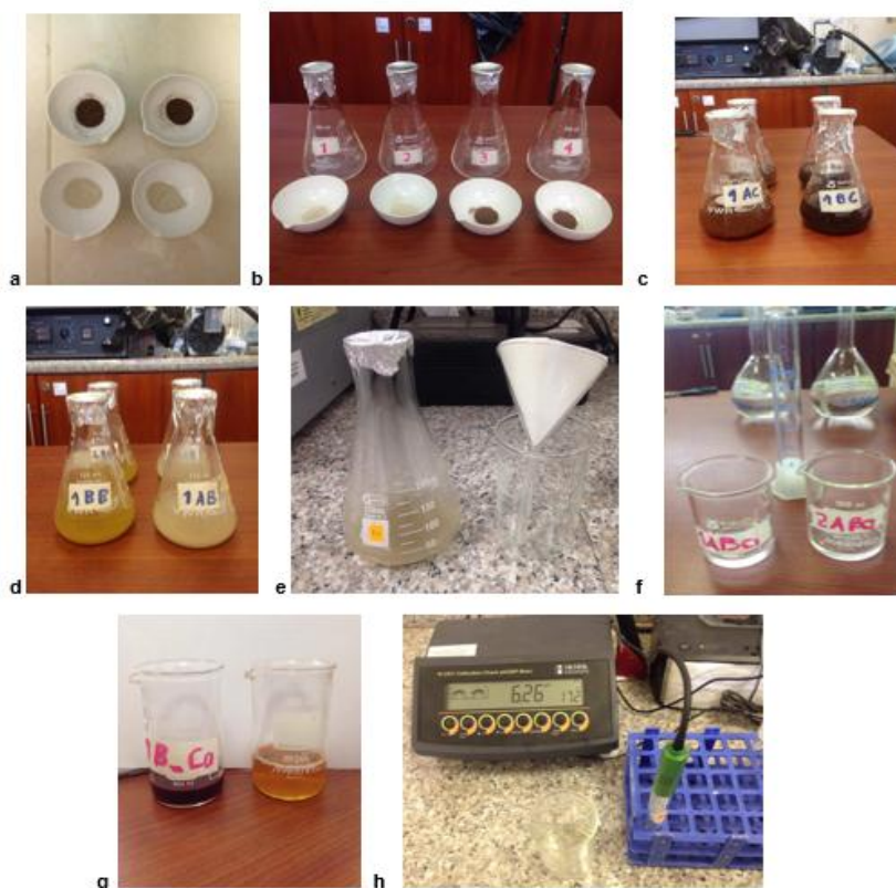
Figura 3. Proceso para determinar los sitios ácidos y básicos
