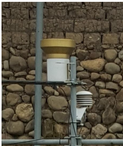
Pluviómetro Tipping Bucket Rain Gage TE525MM marca Texas Electrónica
