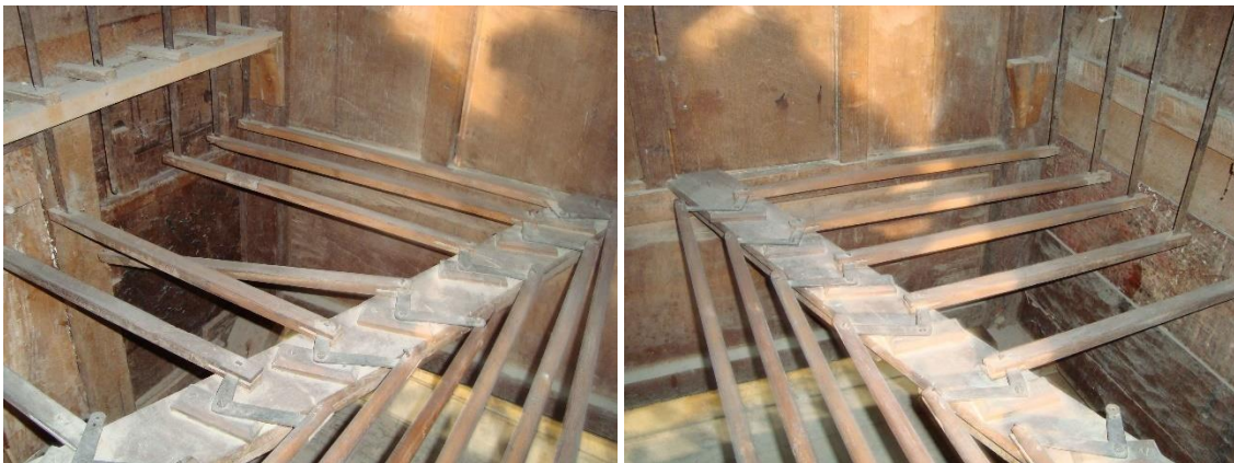
Imágenes 49 y 50 - Reducción de los tiradores de registros que accionan las correderas para cada juego - Mano Izquierda y Mano derecha - (13-05-16)
