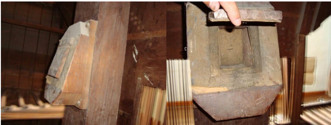
Imágenes 77 y 78 – Trémolo a “vent perdue” (21-09-08)
