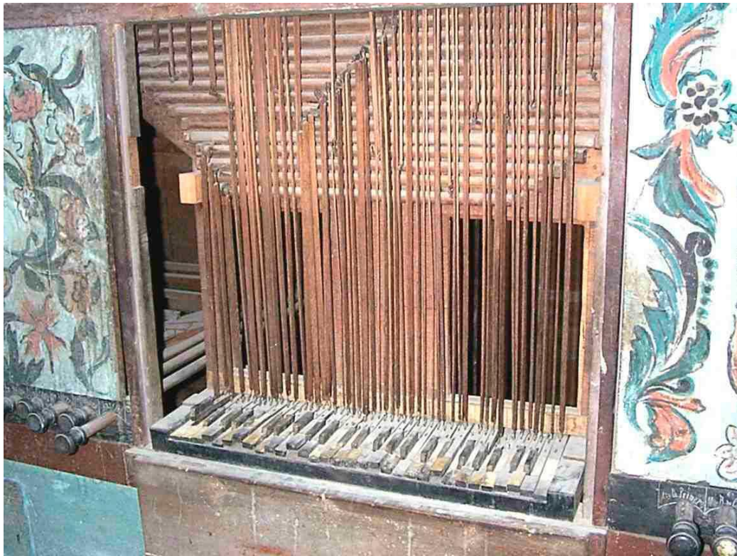
Imagen 11 - (25-01-97) Detalle de la tracción mecánica vertical desde el teclado a la secreta
