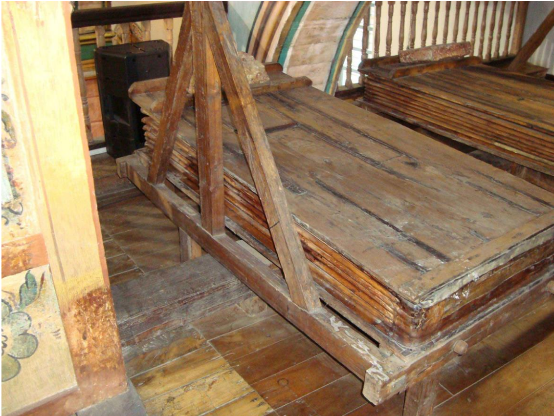
Imagen 5 - Fuelles de cuña originales, cuatro en total (derecha) (13-05-16)
