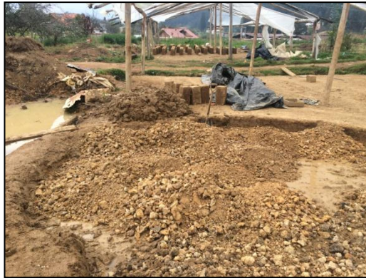
Fotografía 89. Mezcla del material, Fábrica de adobes, Sinincay, 2017 Fuente: Autora
