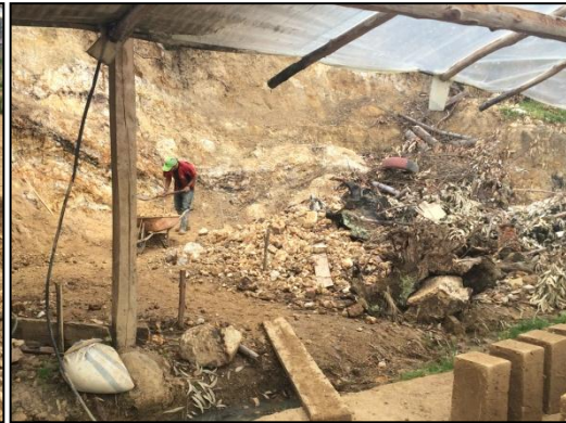
Fotografía 88. Cantera, extracción tierra Fábrica de adobes, Sinincay, 2017 Fuente: Autora
