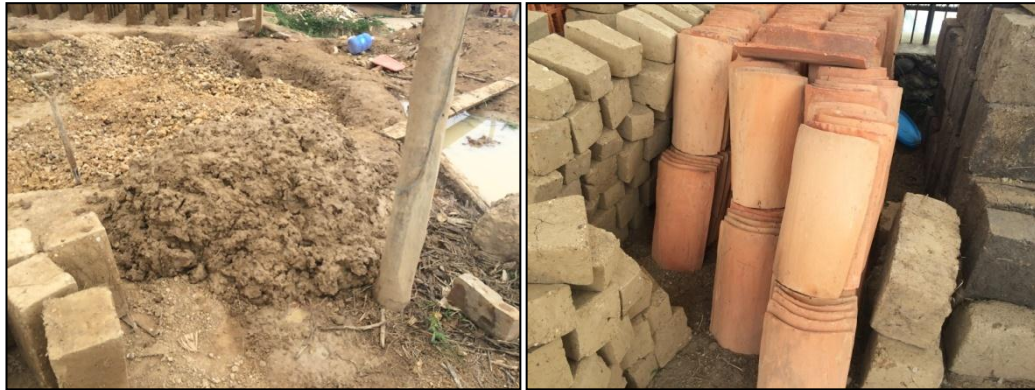
Fotografía 91. Mezcla para revoque, Fábrica de adobes, Sinincay, 2017 Fuente: Autora
