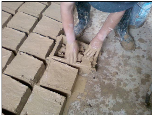
Fotografía 89. Fabricación de adobes, 2014 Fuente: www.elmercurio.com
