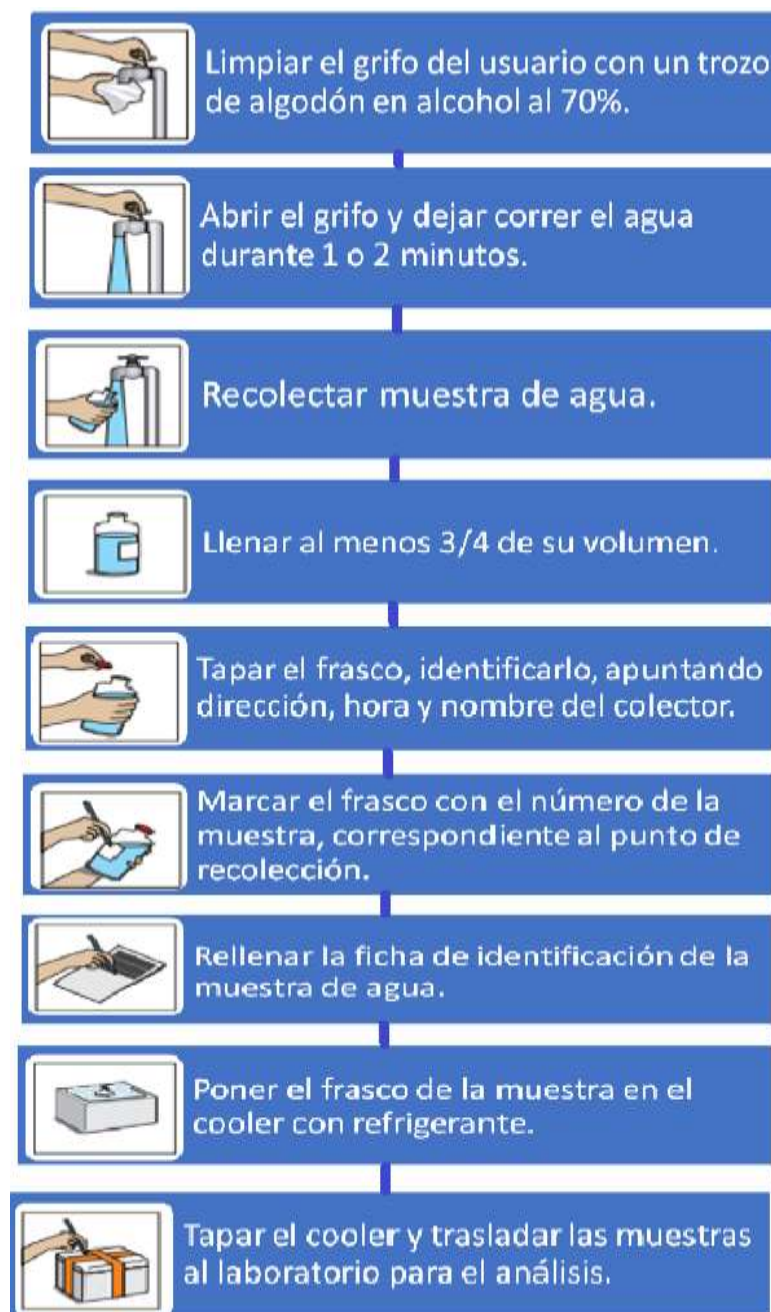
Imagen1°: Procedimiento de recolección de la muestra para análisis microbiológico.
