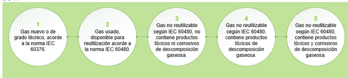
Figura 19. Identificación de contenedores de SF 6 , de acuerdo a la clasificación de la Guía Cigré 234.
