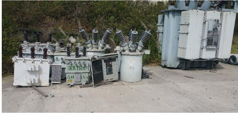
F4: Equipos reconectores dados de baja. Visita técnica a la Bodega de “El Descanso”, CENTROSUR. Fuente: Autor, 2016.
