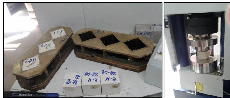
Ilustración 6. Ensayo de resistencia a la compresión de las muestras de cemento 1, 2 y 3.
