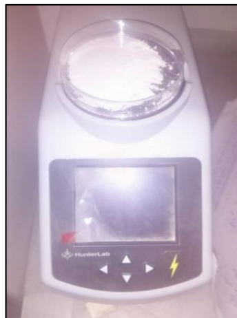
Ilustración 13. Caja Petri con la muestra de carbonato de calcio colocada sobre el espectrofotómetro CIELAB D65/10.
