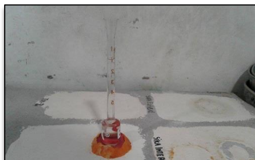
Ilustración 8. Permeabilidad de la superficie (absorción del agua) sobre el sustrato
