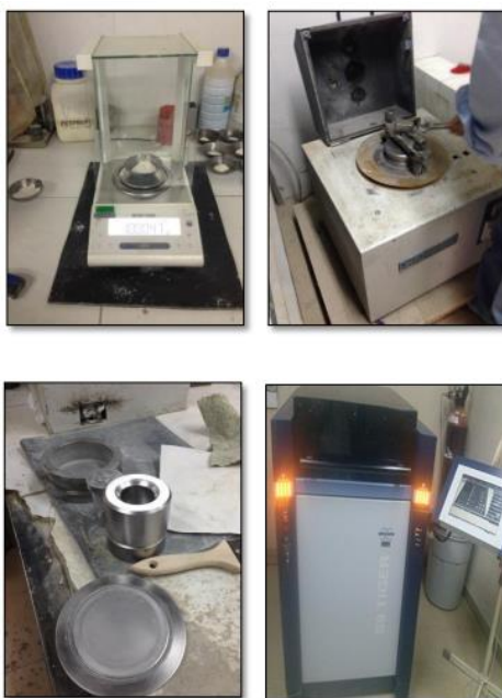
Ilustración 14. Elaboración de la muestra analizada en el espectrofotómetro de fluorescencia de Rayos X Bruker S8 Tiger.
