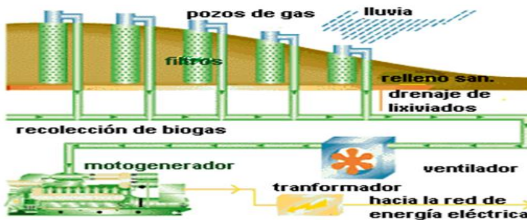
Figura 3.3 Proceso de aprovechamiento del biogás generado en un relleno sanitario Fuente: Ingeniería en Sistemas Energéticos y Ambientales (I.S.E.A) http://isea.webcindario.com/index_archivos/biomasa.htm
