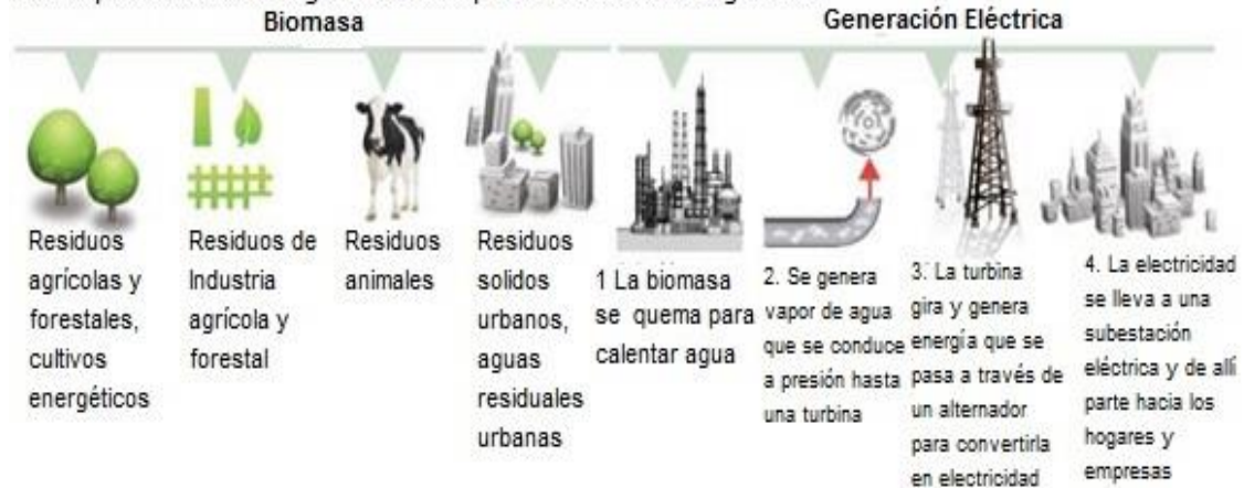
Figura 2.8 Esquema de proceso de una planta eléctrica mediante biomasa.
