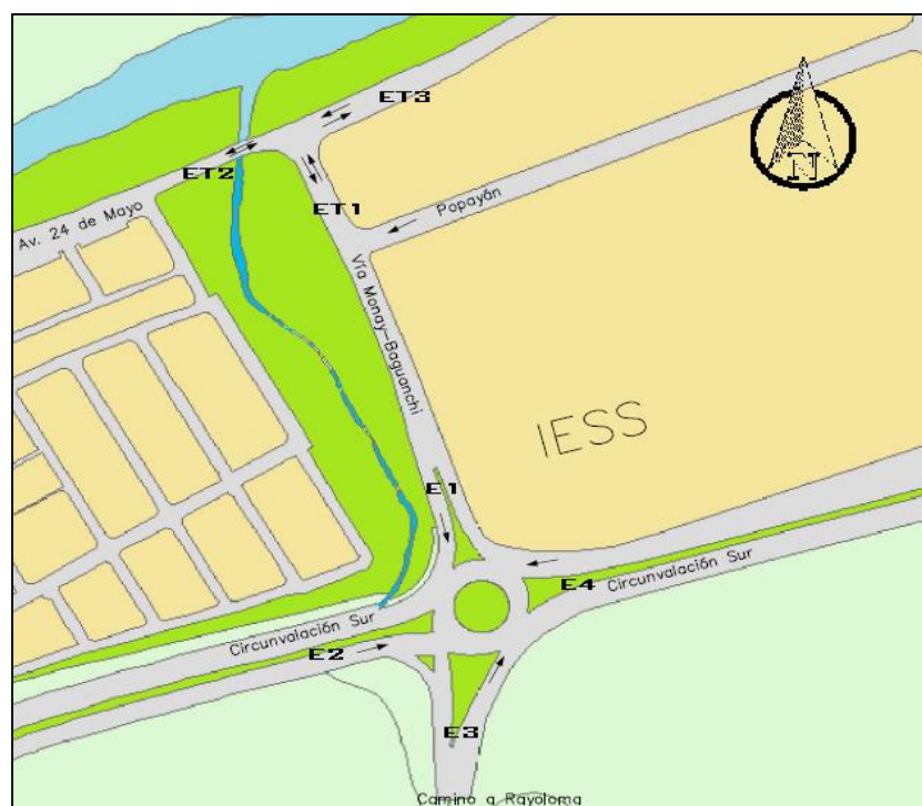
Ilustración 13 Implantación Intersección Tipo Redondel y Tipo T
