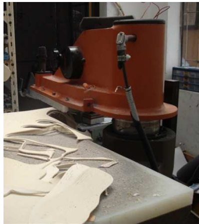
Troquelado de plantillas de terminado en troqueladora
