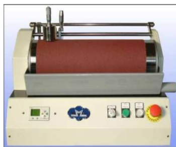
Abrasímetro de cilindro giratorio
