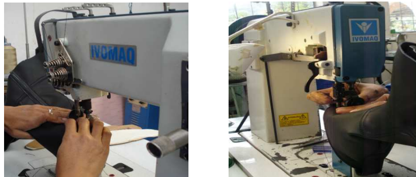
Costura o montaje del calzado
