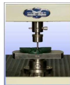
Accesorio para determinar Resistencia a la perforación
