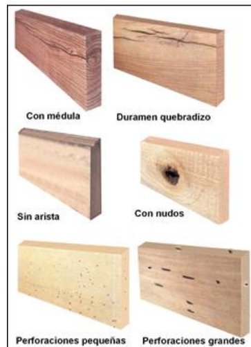
Imagen No. 20 Defectos de la Madera
