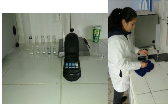
Figuras 32 y 33: Análisis de parámetros en el equipo colorimétrico HACH DR 890
