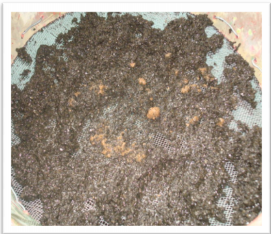
Fig. 57c. Malla de 2mm usado para la determinación de bolas de lodo
