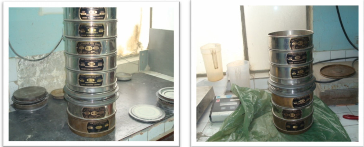
Fig. 55. Tamices empleados en la determinación de la granulometría del medio filtrante
