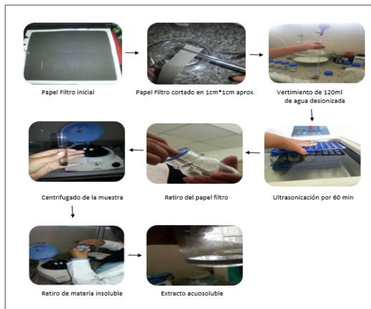
Figura 4.- Proceso para la extracción del extracto acuoso de PM10
