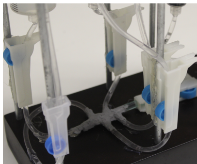
Imagen 12-6. Posición de las llaves cerradas excepto la del depósito.
