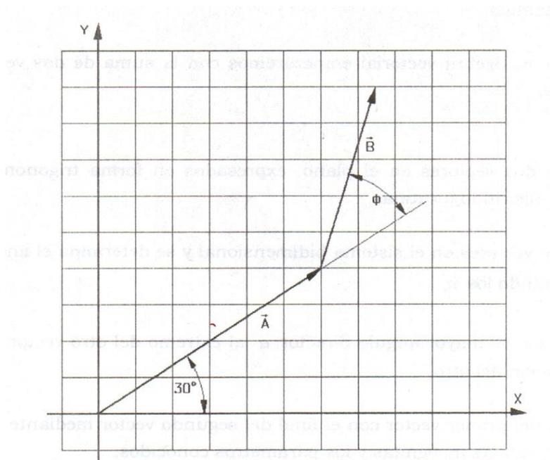
3. Unir el origen del primer vector con el final del segundo vector mediante otro, que lo denominamos vector resultante. Indicamos las incógnitas y los parámetros que se tienen.
