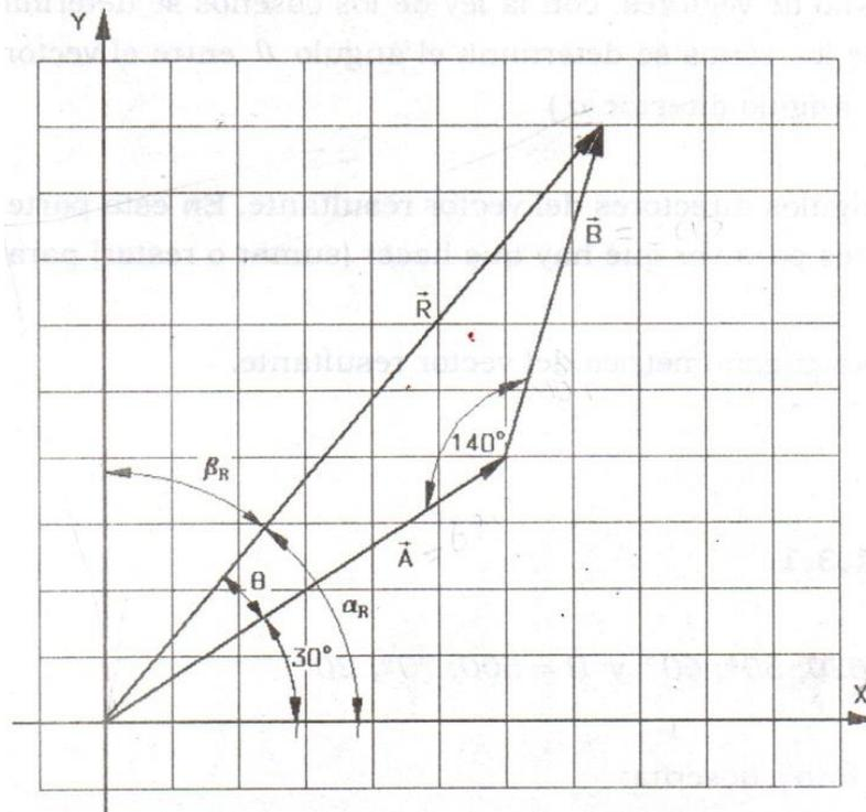
4. Resolvemos el triángulo de vectores utilizando la ley de los cosenos para encontrar la magnitud del vector resultante, y con la ley de los senos determinamos el ángulo  $\theta$  entre el vector resultante y el vector trasladado.
