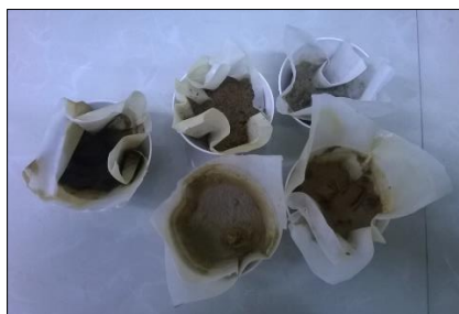
Figura 23. Muestras después de eliminación de extraíbles y antes de ser ingresadas a la estufa.
