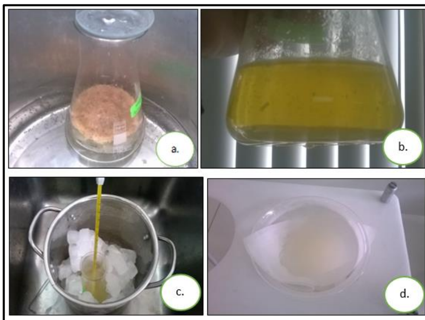
Figura 25. Proceso para la determinación de Holocelulosa en una muestra de Raquis: (a.) Antes del tratamiento con NaClO_2 y CH_3COOH (b.) Después del tratamiento; (c.) Enfriamiento; (d.) Filtración y lavado.
