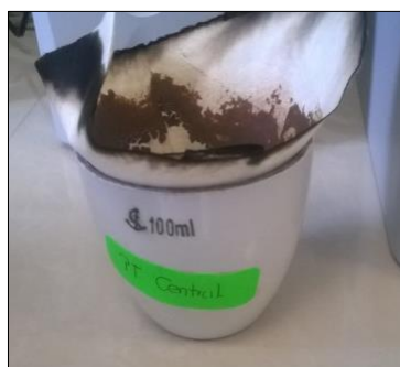
Figura 24. Muestra de Pseudotallo Central después de hidrólisis ácida y secado.
