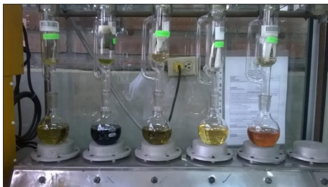
Figura 22. Primera extracción en equipo Soxhlet, de izquierda a derecha, muestras de: raquis, hojas, Pseudopeciolo, Pseudotallo externo y Pseudotallo central.
