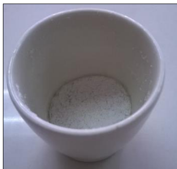
Figura 26. Residuo seco de raquis después del tratamiento de determinación de celulosa
